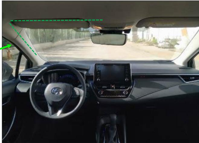
Dado que en este vehículo solamente se admiten como taxímetros los modelos que están ubicados en el espejo retrovisor interior, los cableados necesarios irán por el lado izquierdo del guarnecido del techo desde el plafón de luces y bajarán por el pilar "A" del lado del conductor hasta el cuadro de instrumentos / caja de conexiones bajo volante y demás elementos. En función del tipo de instalación, podría hacerse también por el lado derecho.
