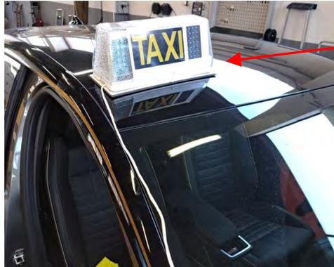
**Fig. 6.2.1.** Vista del módulo sobre soporte imantado
