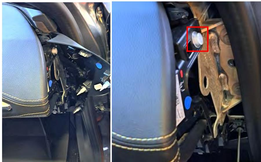
*Fig. 1.6. y 1.7. Detalle tapa lateral salpicadero y tornillo.*
