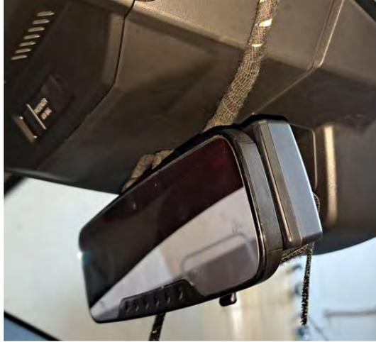
*Fig. 4.4. Taxímetro de espejo superpuesto instalado.*
