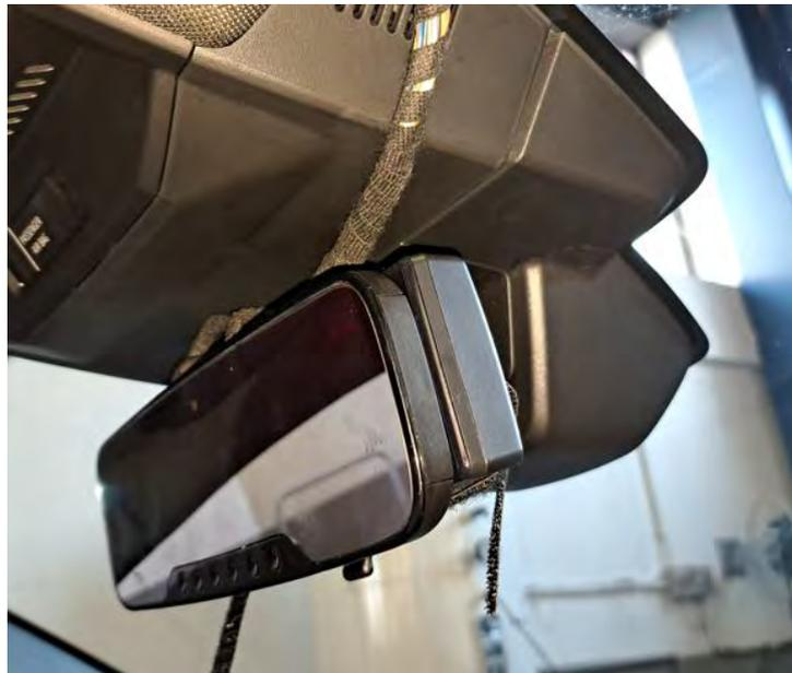
*Fig. 5.1. Vista de taxímetro superpuesto de espejo.*
