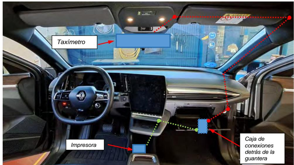
**Fig. 4.1.** Esquema orientativo de las conexiones.
