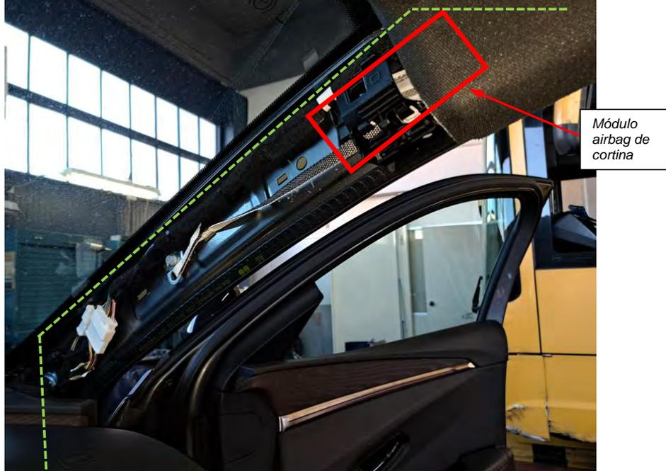
*Fig. 6.2.3. Recorrido de los cables por el interior pilar A derecho.*
