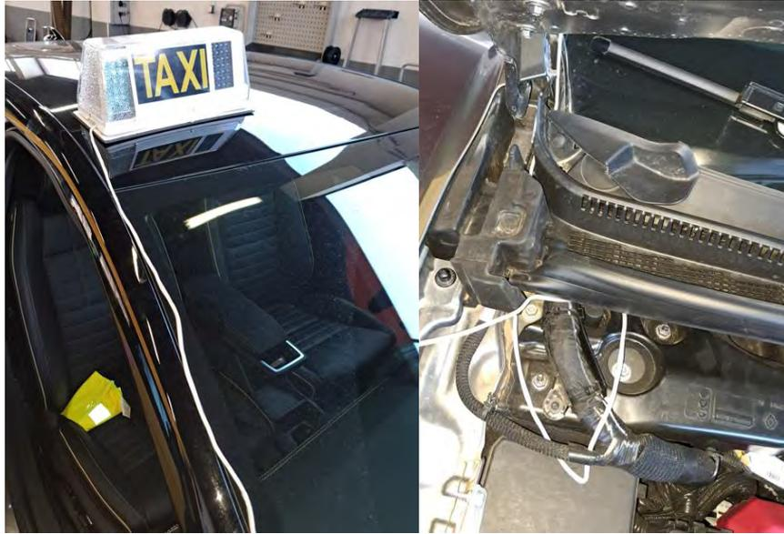
*Fig. 6.2.4. Recorrido de los cables por vierteaguas del pilar A derecho.*
