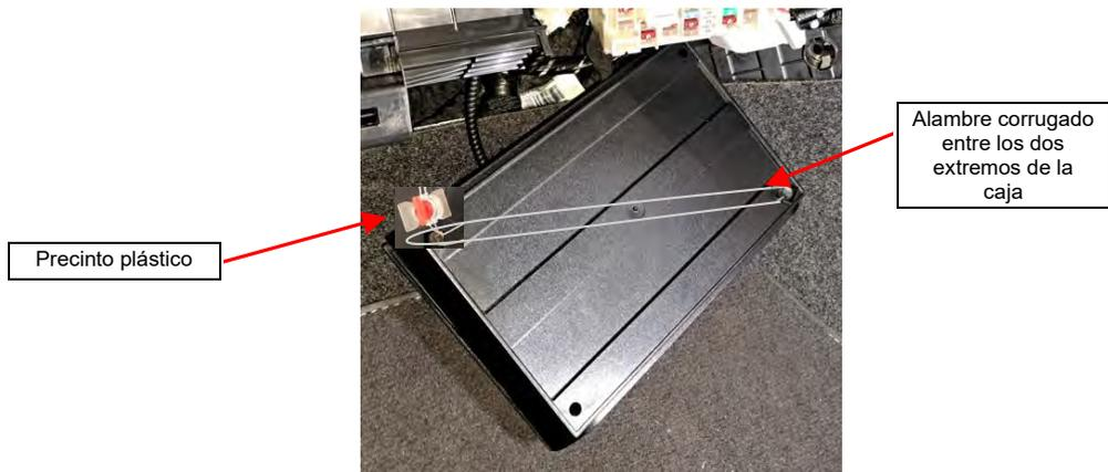
*Fig.2.2.4. Detalle precintado con precinto plástico.*
