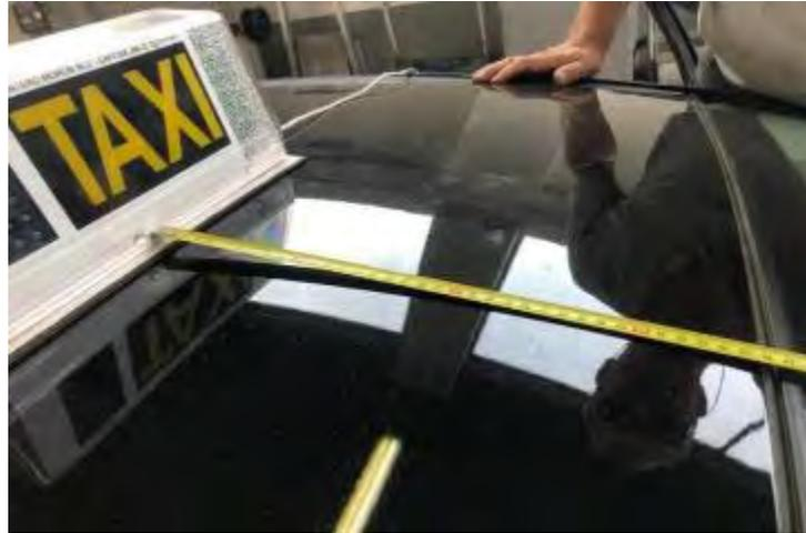
Para el montaje del conjunto luminoso es necesario practicar tres orificios (dos para atornillar el módulo, de  $\varnothing 7$  mm, y el otro centrado para la conducción eléctrica, de  $\varnothing 16$  mm) en el techo del vehículo. Se procederá al desmontaje del guarnecido interior del techo para acceder a la zona.
