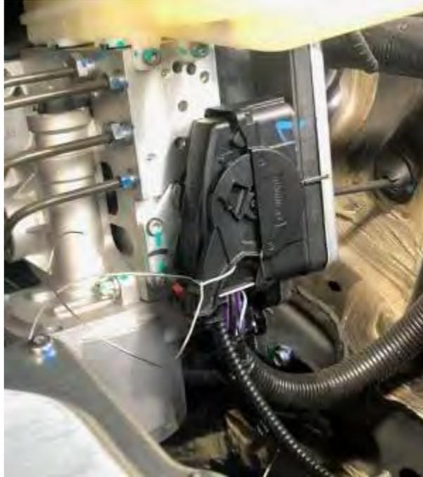
Finalmente se colocará precinto plástico rotativo sobre los extremos libres del alambre, de manera que se impida el desmontaje sin retirar el precinto o cortar el alambre.
