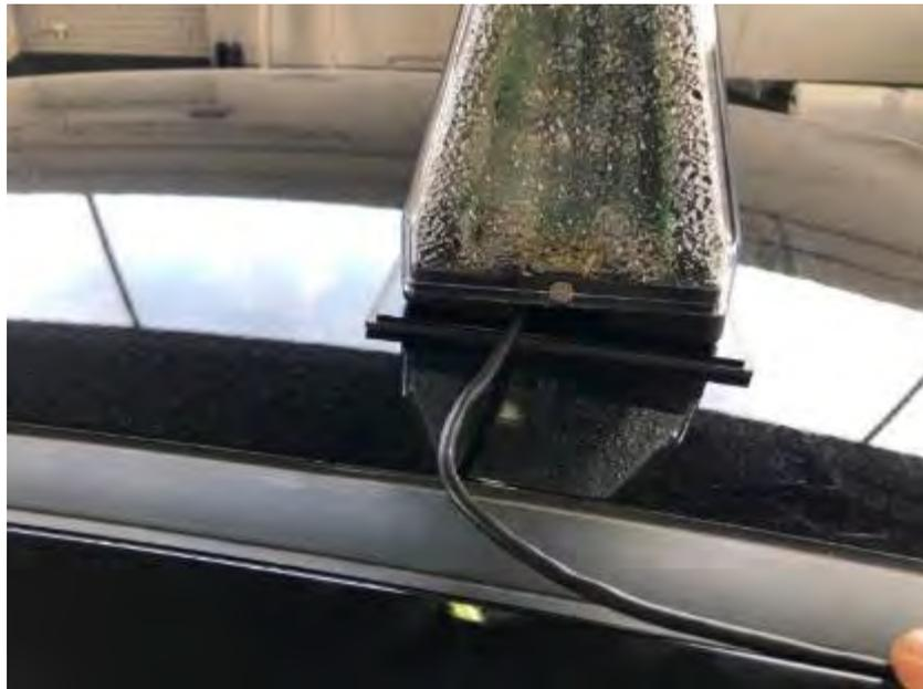
La manguera de conexión se pasará por el exterior del techo hasta el vierteaguas derecho. Se podrá fijar en su recorrido por el techo con grapas adhesivas o con canaleta plástica adhesiva.
