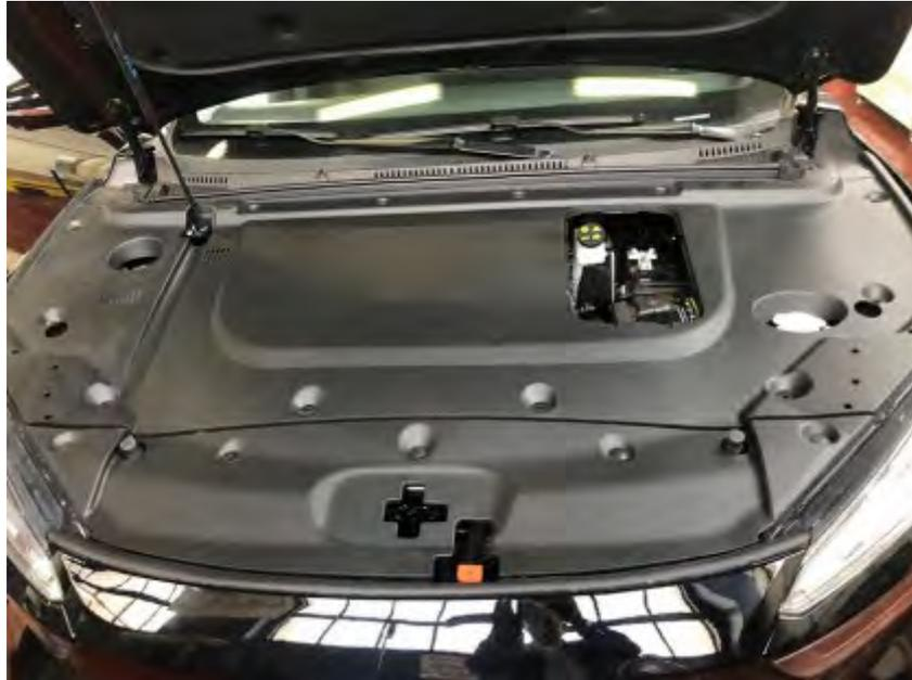
La señal de velocidad se tomará del conector eléctrico del módulo del ABS, ubicado en el compartimento motor frente al conductor. En la siguiente figura se identifican las zonas a intervenir:
