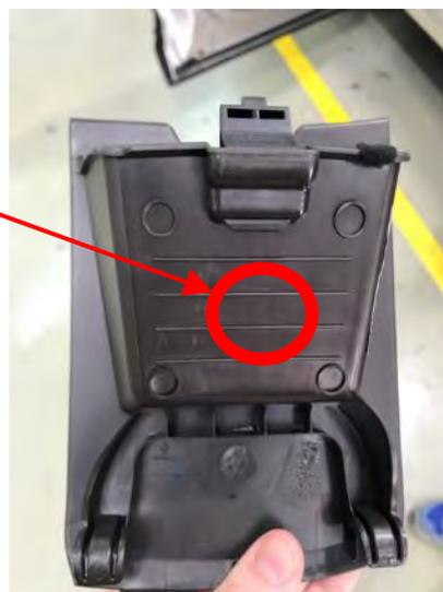
*Fig 3.1.2. Zona de paso de cables en la guantera.*
