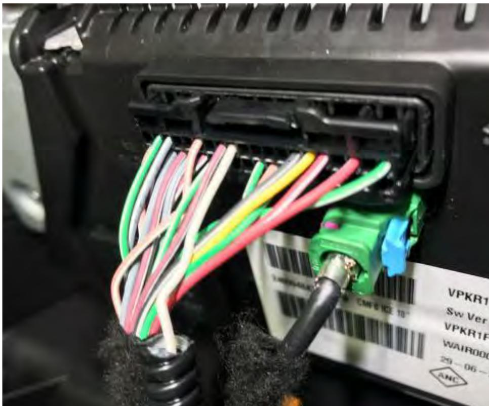
**Fig. 2.3.2.** Detalle conexión cable y manguera blindada al conector 247
