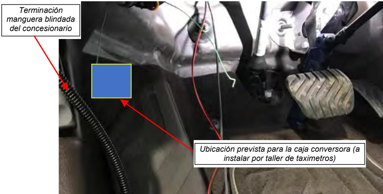
*Fig. 2.3.3. Detalle ubicación de caja conversora de señal.*
