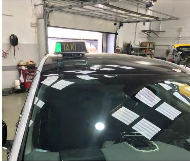
*Fig. 6.3. Vista del módulo luminoso desplazado.*
