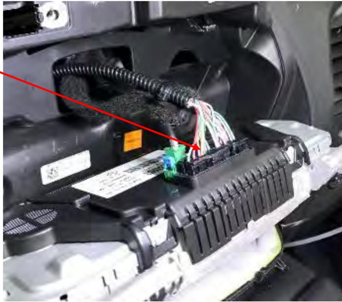
*Fig. A2.1.2. Vista del conector 247 con el cuadro desmontado*
