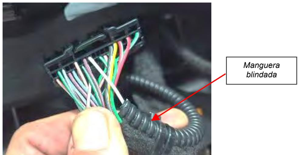
*Fig. 2.2.1. Detalle manguera*
