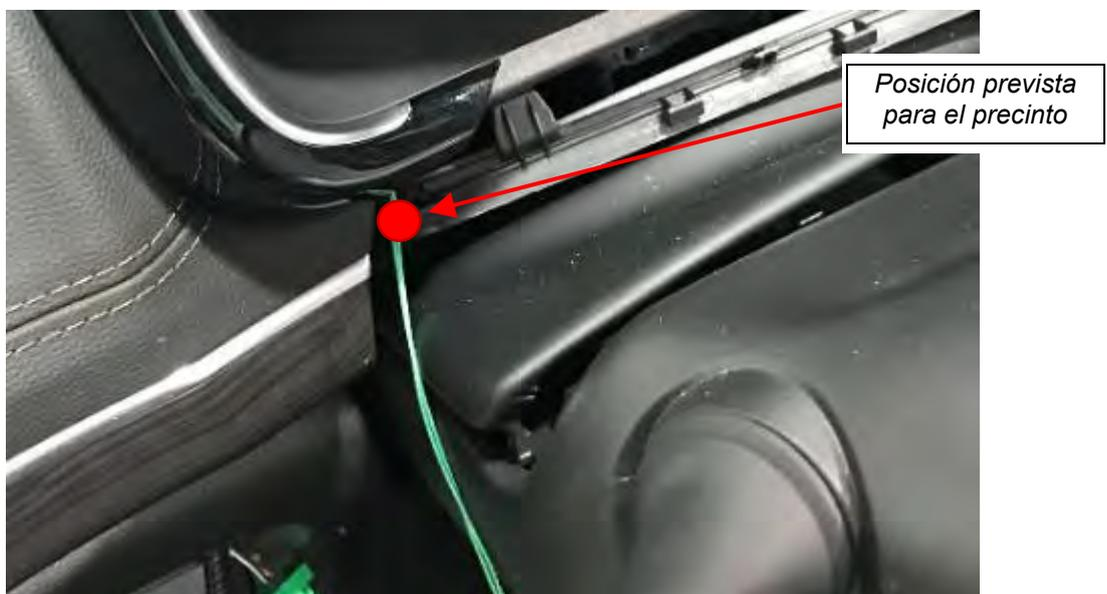
**Fig. 2.2.7.** Posición del precinto del concesionario
