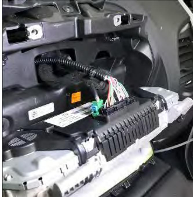
*Fig. 2.2.3. Detalle paso de manguera blindada a la zona posterior del cuadro desde el conector 247*
