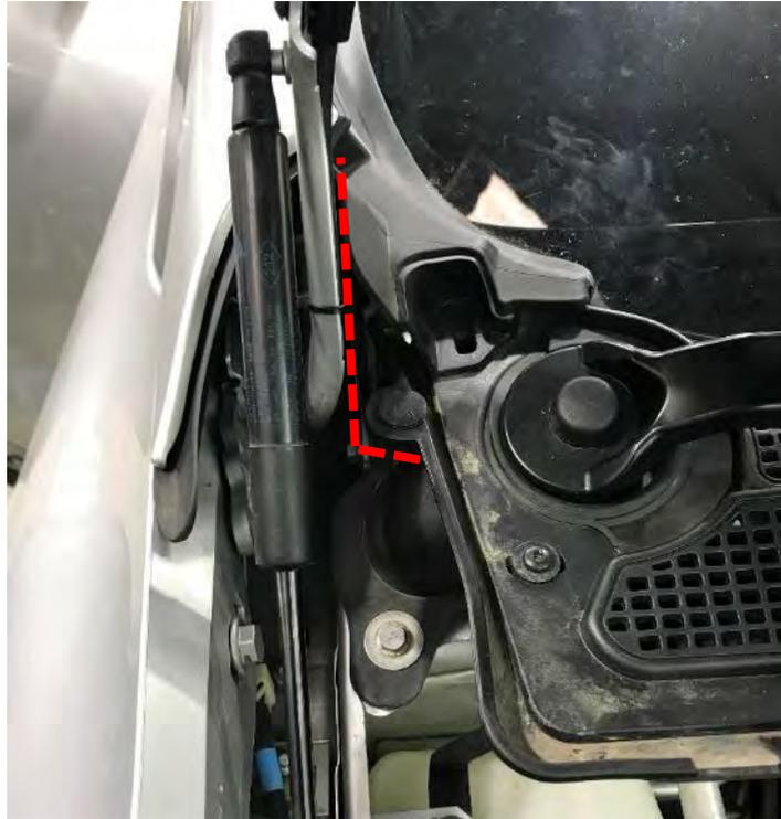
*Fig. 6.7. Recorrido del cable del módulo*
