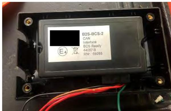
**Fig. 3.2.2.** Ejemplo de caja convertora de impulsos instalada dentro de la caja de conexiones
