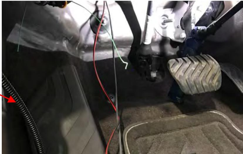
**Fig. 3.2.1.** Vista de la terminación de la manguera blindada puesta por el concesionario
