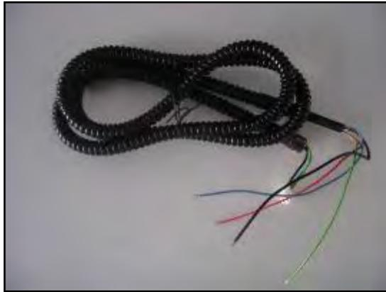
Para la toma de señal digital se utilizará una manguera de 2 pares trenzados apantallados.
