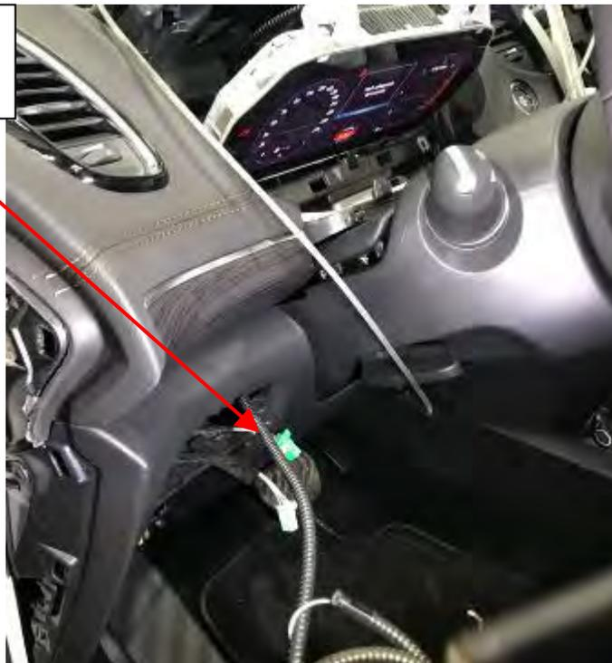
*Fig. 2.2.4. Detalle del extremo libre de la manguera en la caja de fusibles.*
