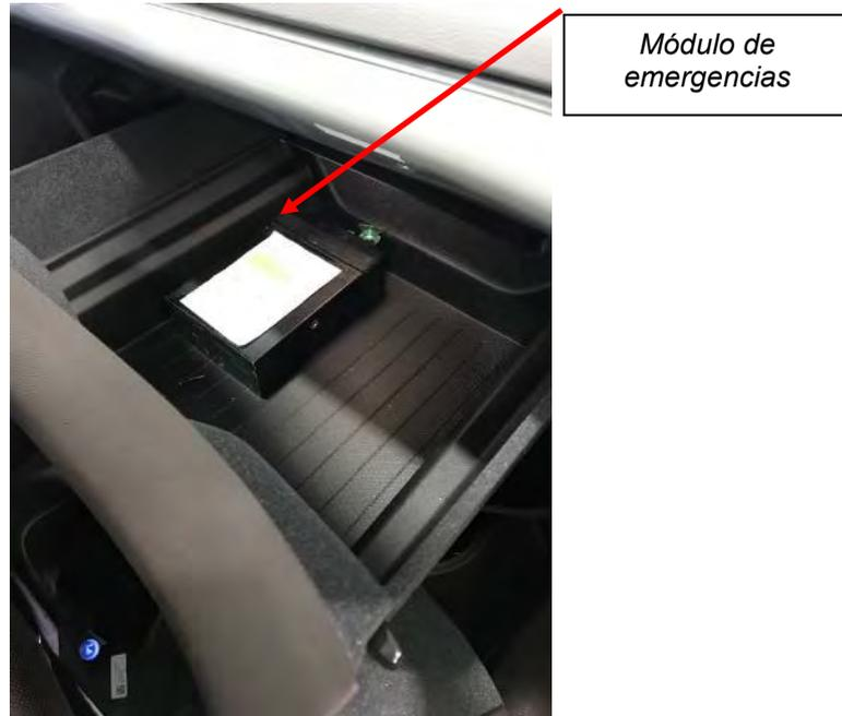
*Fig. 7.1. Vista del emplazamiento del módulo de emergencias.*
