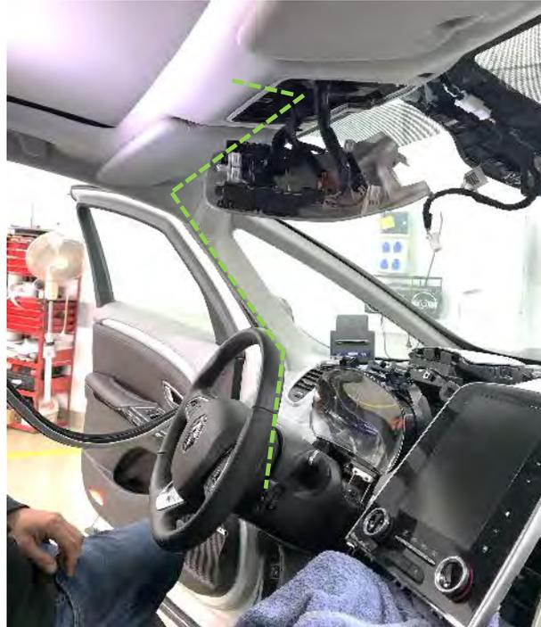
*Fig. 4.4. Recorrido de los cables hasta el plafón superior*
