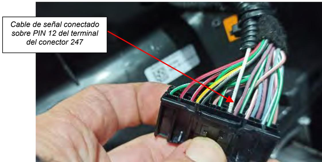
*Fig. 2.2.1. Detalle cable del pin 12 del conector 247*
