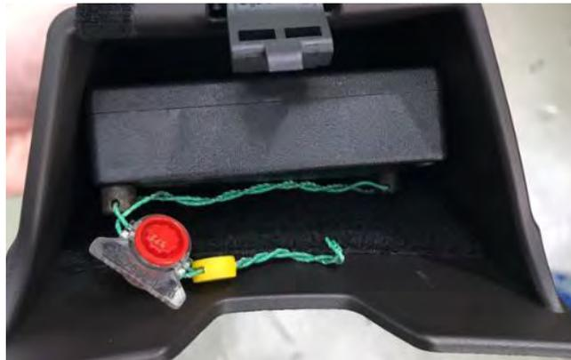
*Fig 3.1.3. Imagen de la caja de conexiones precintada.*
