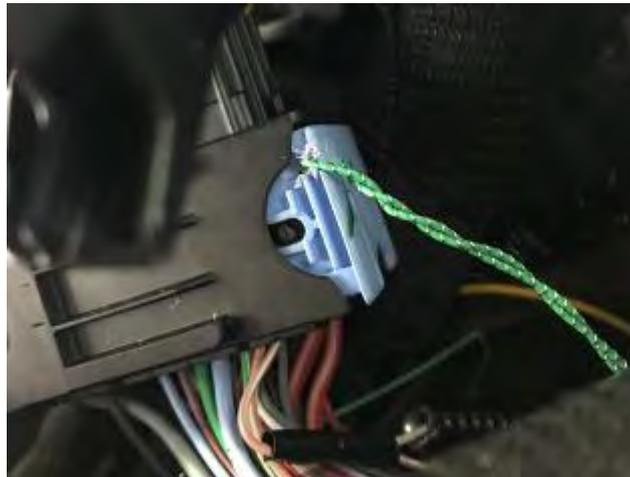
*Fig. 3.4. Paso de alambre corrugado por el cierre del conector R107.*
