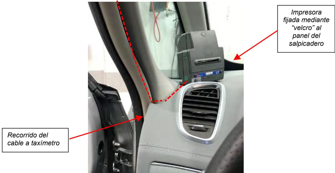
**Fig. 5.1.** Vista de la disposición de la impresora.
