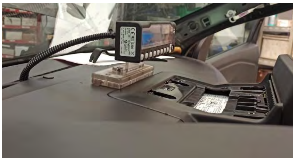
Fig. 5.1 y 5.2. Vistas de la ubicación de taxímetro consola sobre salpicadero.
