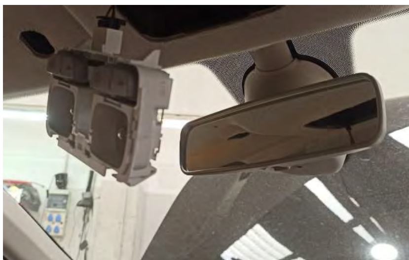
Fig. 5.4. Vista del plafón desmontado y del retrovisor original.
