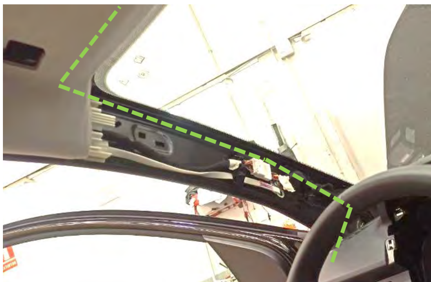
Fig. 4.7. Recorrido de los cables por el interior del guarnecido del marco del parabrisas.
