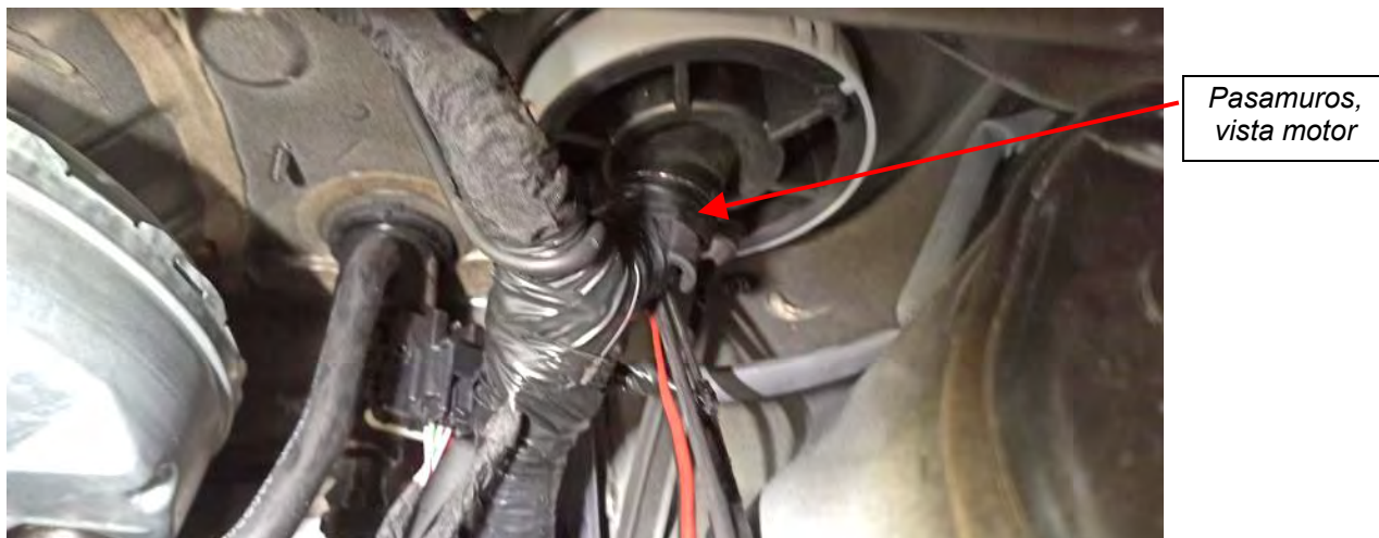
Fig. 2.2. Detalle pasamuros, vista compartimento motor
