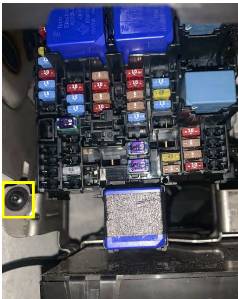
Fig. 2.6. Detalle de conexión negativo de masa a chasis.
