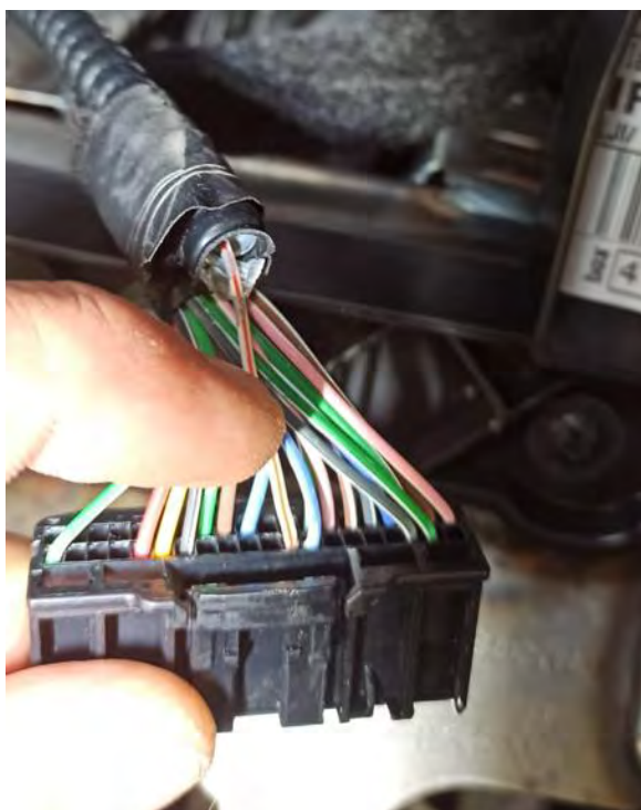
Fig. 1.3. Vista del conector 247 del cuadro de instrumentos
