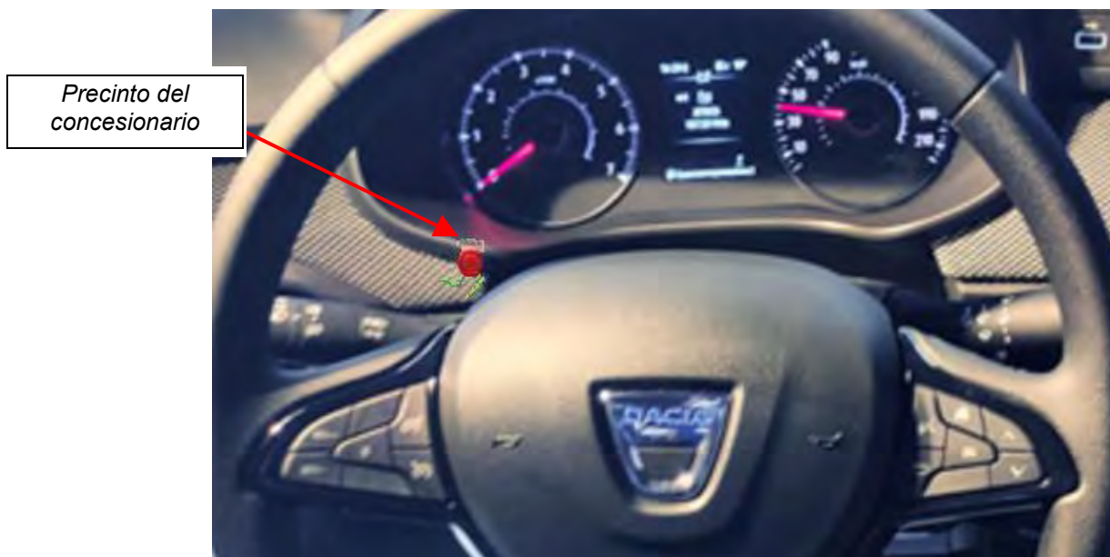
Fig. 2.6. Vista final del montaje precintado
