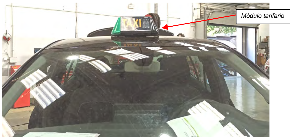
Fig. 6.1. Vista frontal ejemplo módulo centrado atornillado
