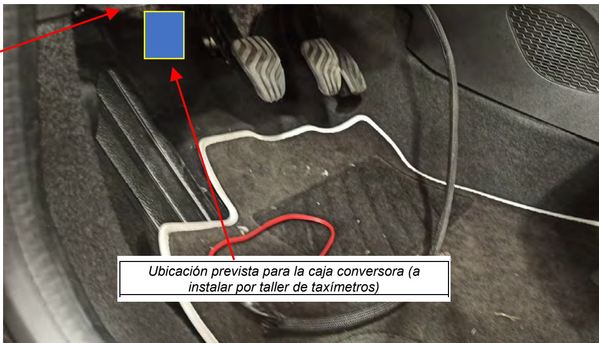
Fig. 2.2.4. Detalle ubicación de caja convertora de señal.
