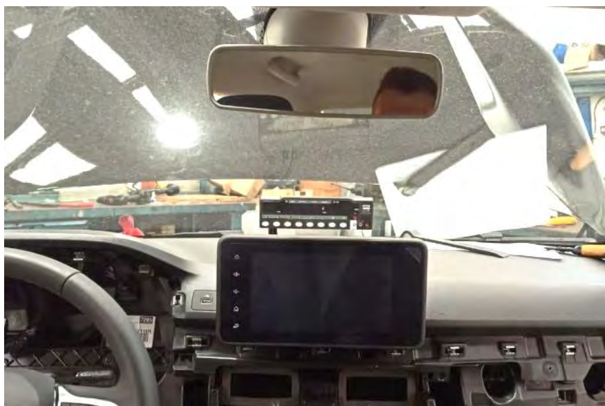
Fig. 5.3. Vista posterior de taxímetro consola sobre salpicadero.
