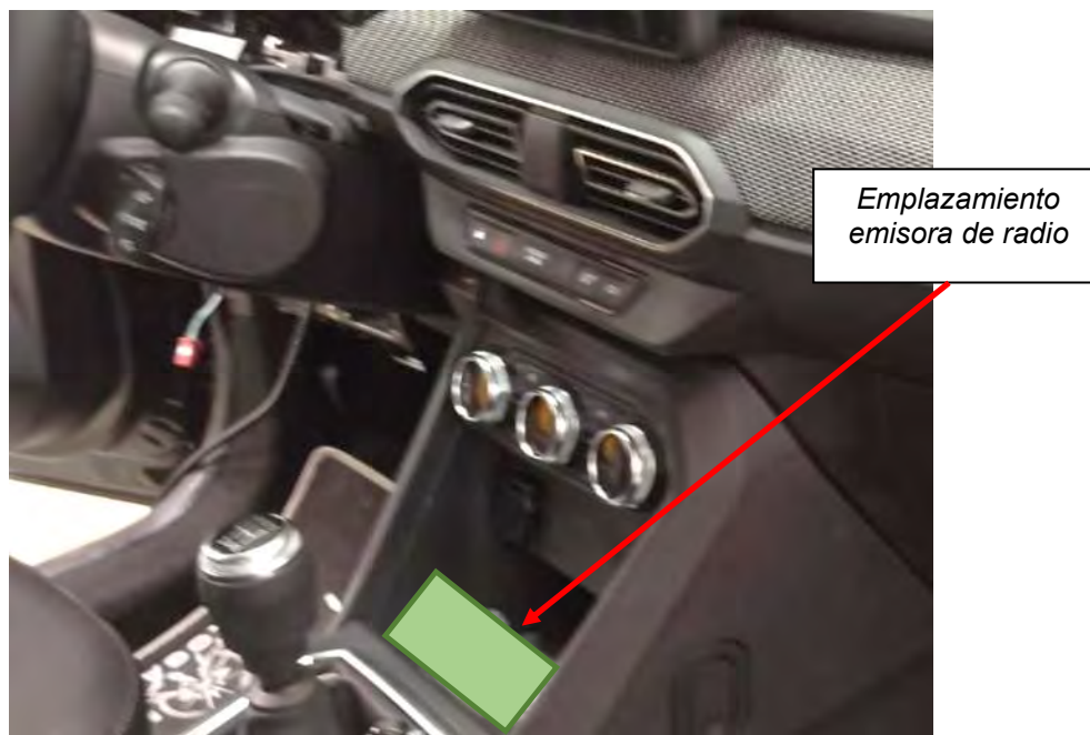
Fig. 7.5. Vista del emplazamiento de la emisora.
