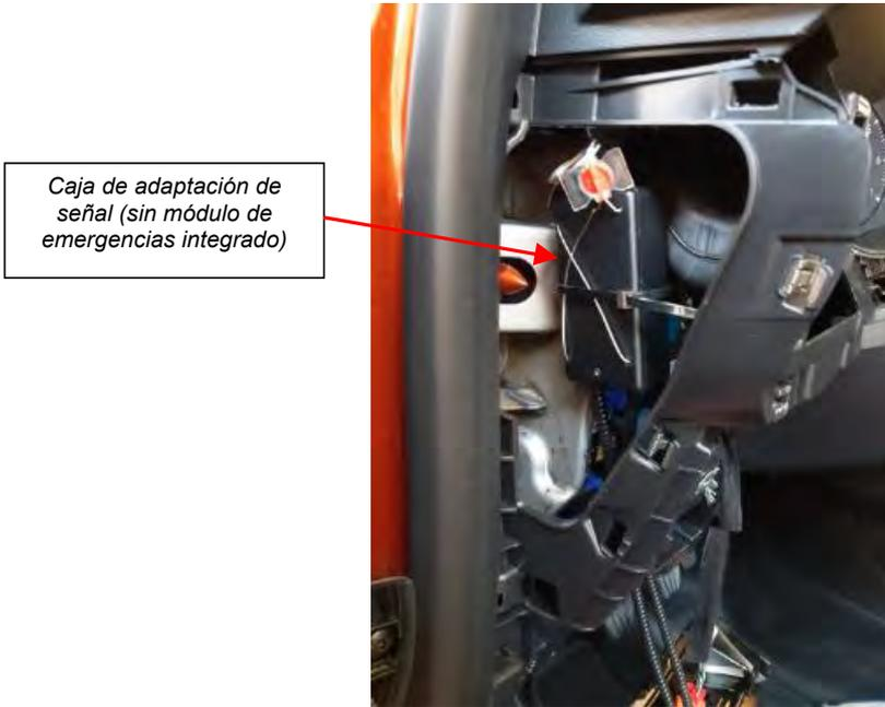
*Fig. 3.3. Vista del compartimento lateral con la caja adaptadora de señal y detalle de precintos.*
