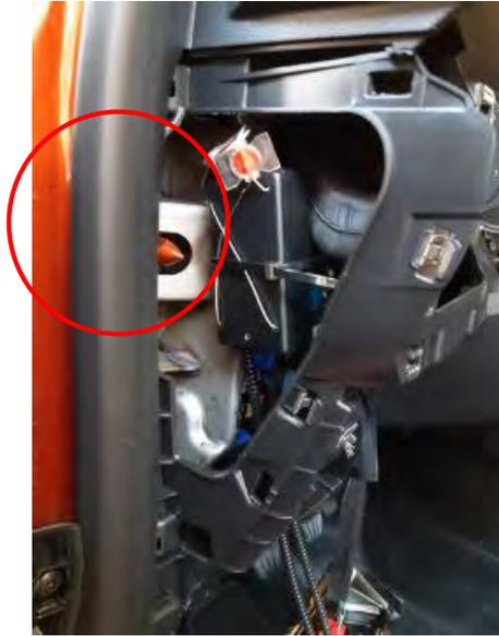
*Fig. 4.6. Zona de paso del cableado*
