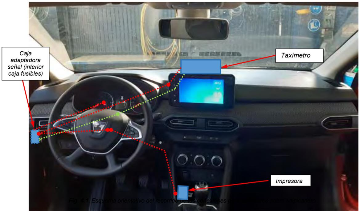
Fig. 4.1. Esquema orientativo del recorrido de las cables desde la caja adaptadora.
