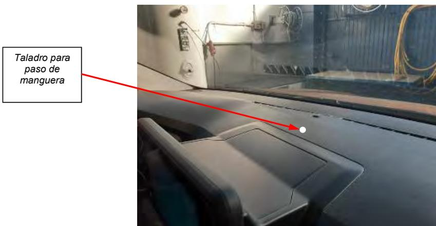
Fig. 4.2. Detalle taladro para paso de manguera
