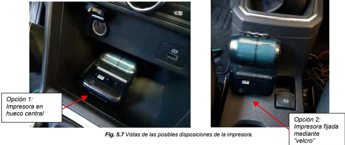
*Fig. 5.7 Vistas de las posibles disposiciones de la impresora.*
