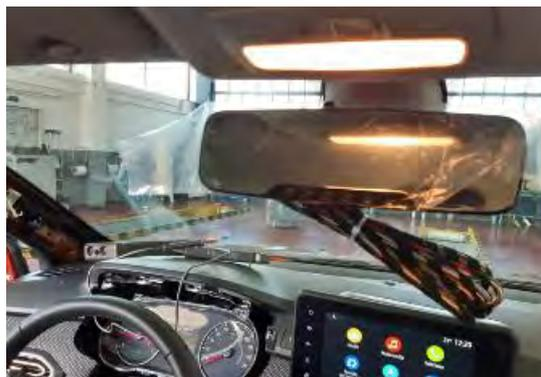
*Fig. 5.5. Vista del taxímetro de espejo*
