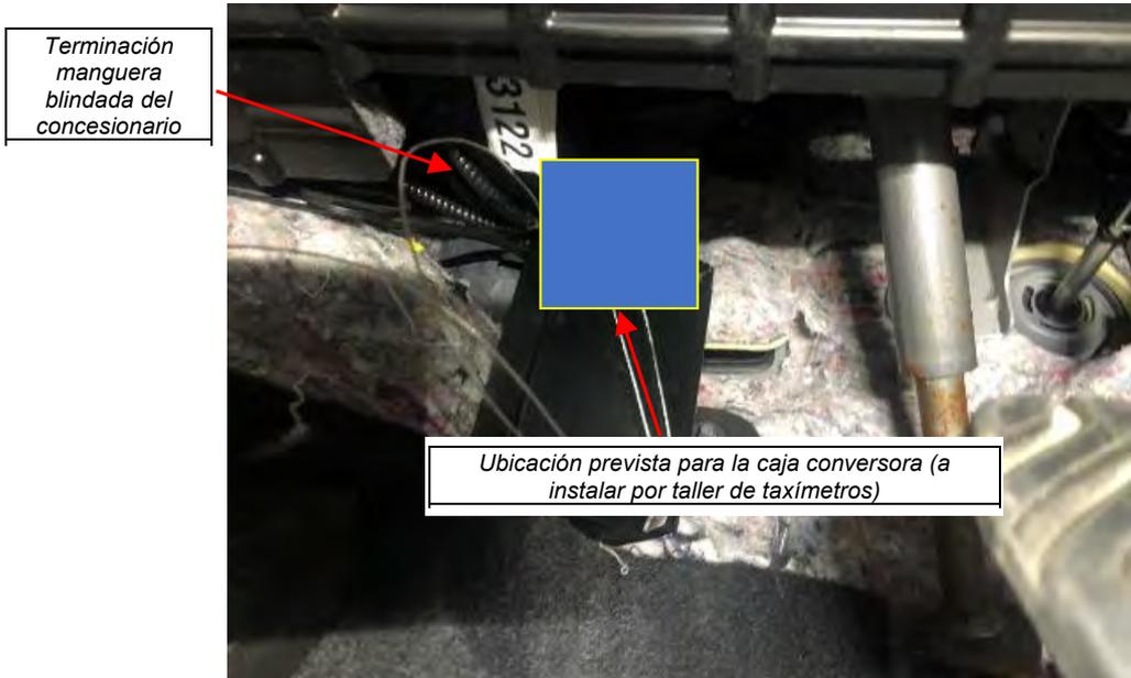
*Fig. 2.2.4. Detalle ubicación de caja convertora de señal.*
