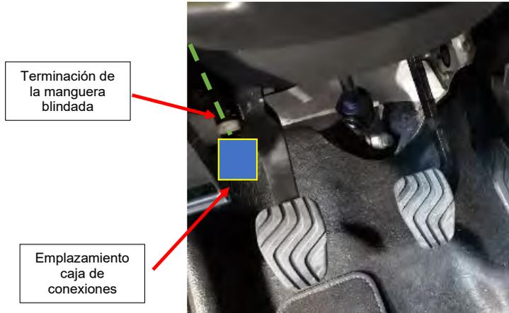
**Fig. 3.1.1.** Vista de la terminación de la manguera blindada puesta por el concesionario
