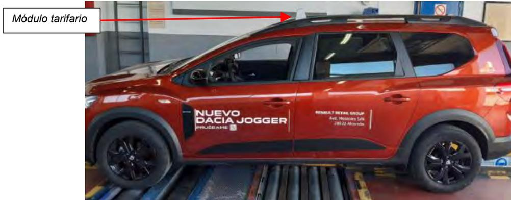
*Fig. 6.2. Vista lateral ejemplo módulo centrado atornillado*
