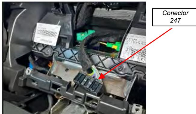
Fig. 1.2. Vista del conector 247 con el cuadro de instrumentos desmontado
