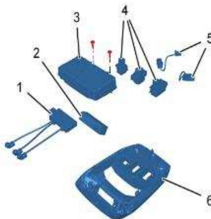
Para el montaje del conjunto luminoso es necesario practicar tres orificios (dos para atornillar el módulo, de  $\varnothing 7$  mm, y el otro centrado para la conducción eléctrica, de  $\varnothing 16$  mm) en el techo del vehículo.
