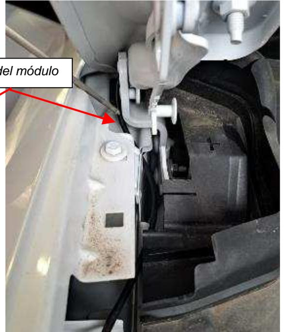
Posteriormente se conducirá por debajo del vierteaguas, embridándolo para que no quede suelto, hasta el mismo pasamuros, entrando al habitáculo por encima de los pedales del conductor, y desde ahí hasta la caja de conexiones ubicada junto al VSM.
