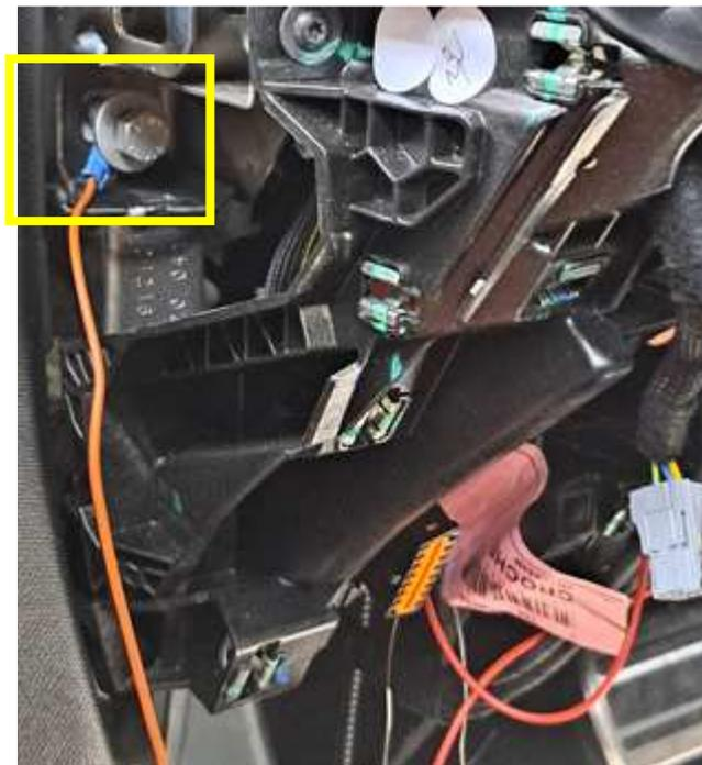
Posteriormente los cables de alimentacion se enfundarán en un cable de material plástico autoextinguible y se dejará en la parte inferior del salpicadero, bajo el volante, junto con la manguera con el cable de señal.
