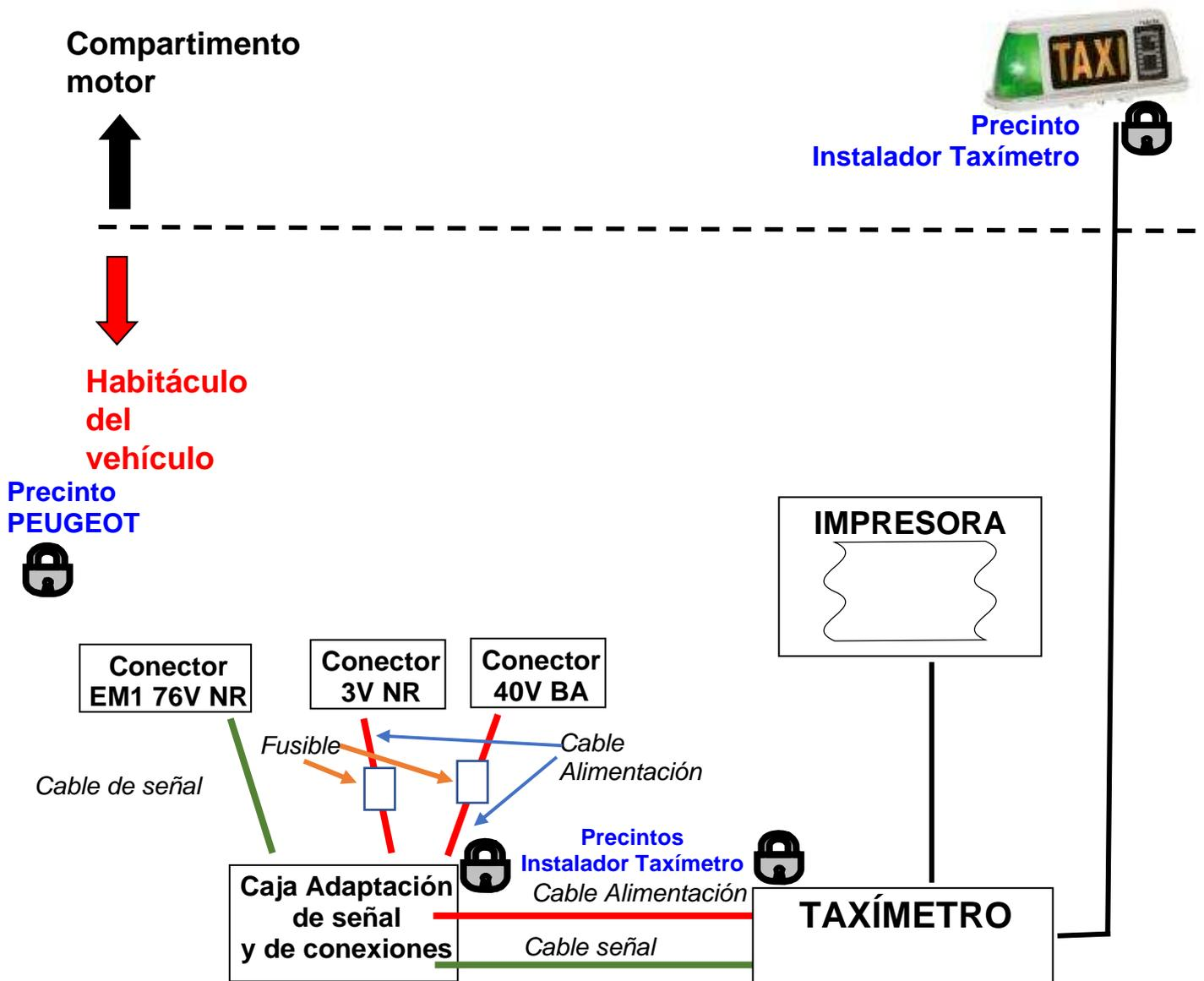
**Fusible:** Capacidad en función de los elementos a conectar, valor marcado por el fabricante del elemento o dispositivo.
