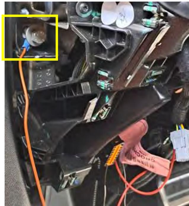
Posteriormente los cables de alimentación se enfundarán en un cable de material plástico autoextinguible y se dejará en la parte inferior del salpicadero, bajo el volante, junto con la manguera con el cable de señal.
