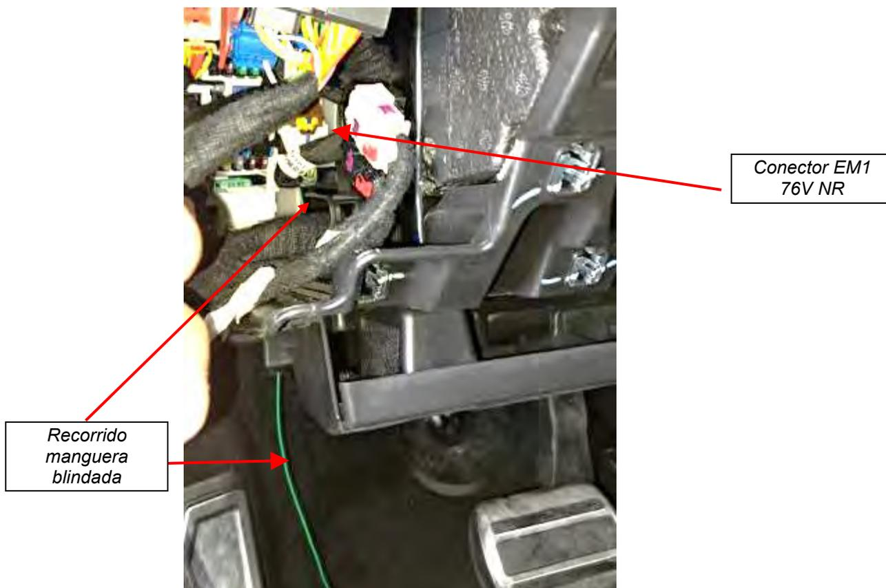
El cable de señal se enfundará en la manguera blindada, y la terminación se embridará al mazo de cables del conector para impedir su desmontaje.
