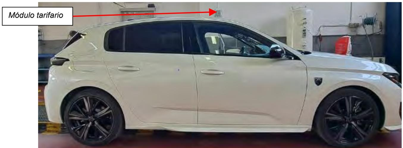
La manguera de conexión pasará desde el módulo tarifario al interior del techo a través del orificio practicado en el mismo. La manguera discurrirá por el interior del pilar A hasta la caja adaptadora de señal, de forma similar al recorrido que tiene la manguera del taxímetro de espejo.
