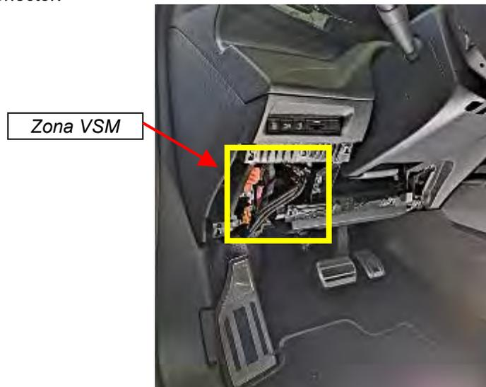
El positivo +30 se tomará de la **vía 1** del conector **3V NR**, situado en esta misma zona, así como el positivo +15, que se tomará de la **vía 18** del conector **40V BA**.
