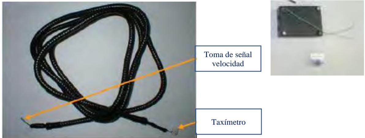
La manguera lleva en su interior 1 cable de sección 0,25 mm. Para las instalaciones en vehículos de la marca PEUGEOT, solo se utiliza el cable que es el de señal, para la caja adaptadora.
