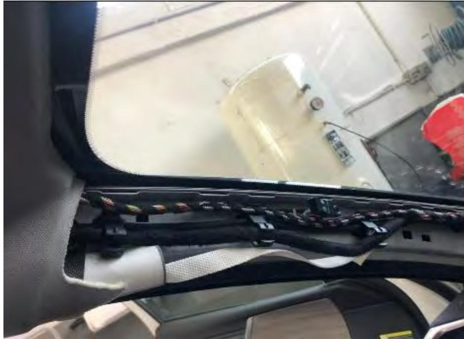
**IMPORTANTE:** Pasar la manguera blindada entre la caja de conexiones y el taxímetro de espejo por la parte superior del módulo de airbag de cortina en el pilar A (conductor).
