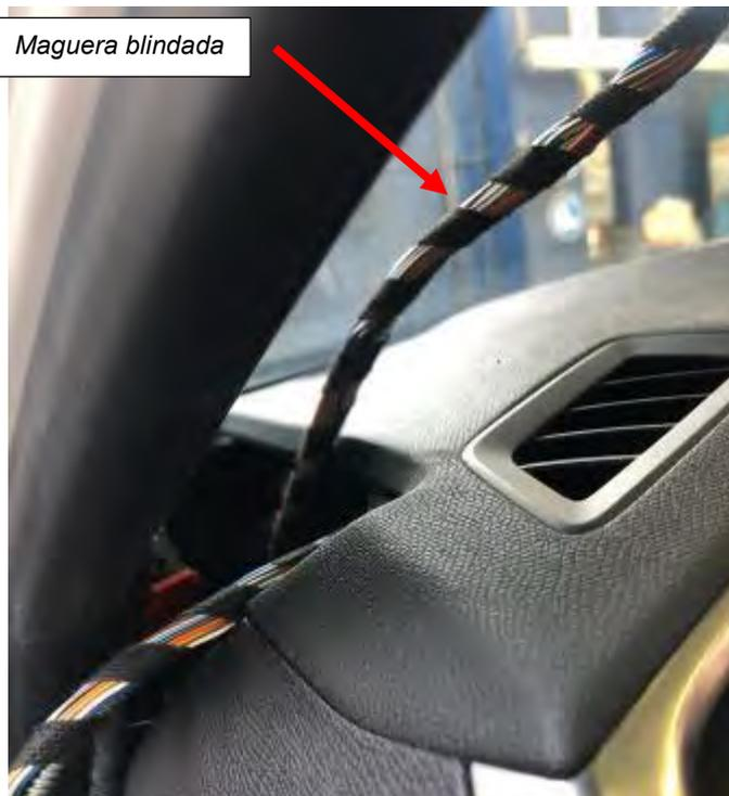
**IMPORTANTE:** Pasar la manguera blindada entre la caja de conexiones y el taxímetro de espejo por la parte superior del módulo de airbag de cortina en el pilar A (conductor).
