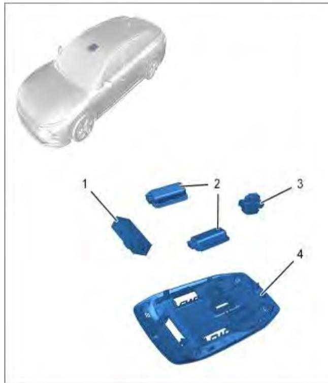
Para el montaje del conjunto luminoso es necesario practicar tres orificios (dos para atornillar el módulo, de  $\varnothing 7$  mm, y el otro centrado para la conducción eléctrica, de  $\varnothing 16$  mm) en el techo del vehículo.
