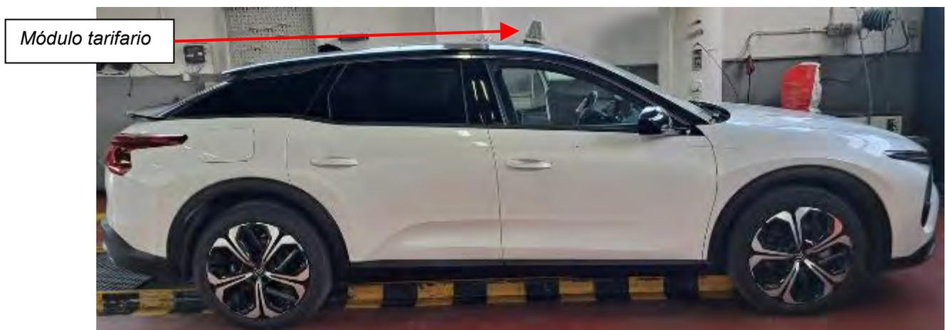
La manguera de conexión pasará desde el módulo tarifario al interior del techo a través del orificio practicado en el mismo. La manguera discurrirá por el interior del pilar A hasta la caja adaptadora de señal, de forma similar al recorrido que tiene la manguera del taxímetro de espejo.
