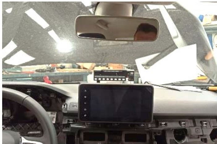
Fig. 5.4. Vista posterior de taxímetro consola sobre salpicadero con pantalla.
