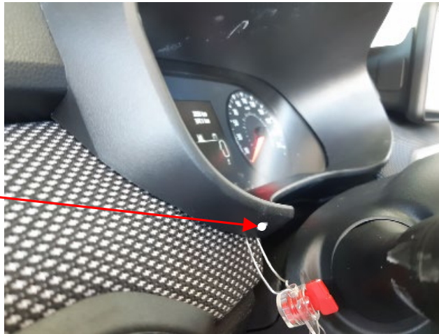
Fig. 2.5. Identificación de los taladros para el paso de alambre de precinto.
