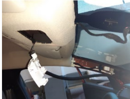
Fig. 5.4. Vista del plafón desmontado.
