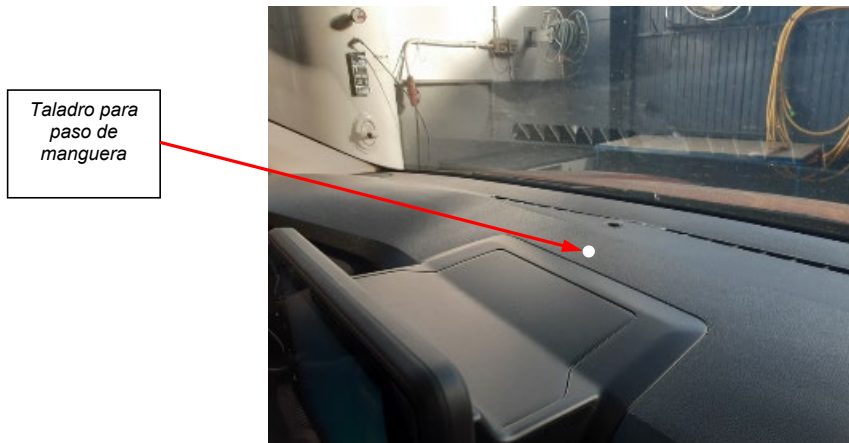
Fig. 4.2. Detalle taladro para paso de manguera
