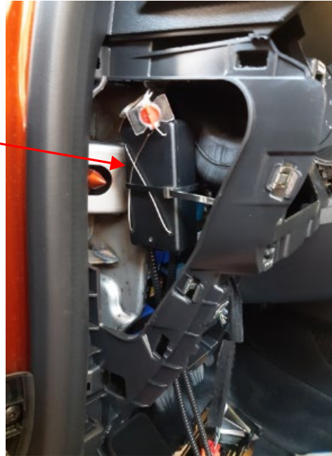
Fig. 3.3. Vista del compartimento lateral con la caja adaptadora de señal y detalle de precintos.
