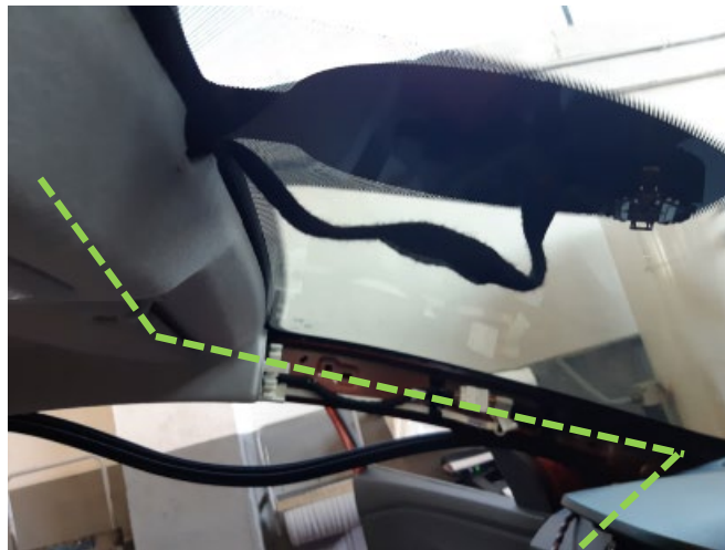
Fig. 4.7. Recorrido de los cables por el interior del guarnecido del marco del parabrisas.
