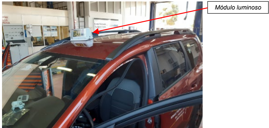
Fig. 6.4. Vista del módulo luminoso desplazado
