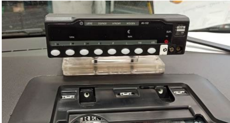
Fig. 5.2 Ubicación de taxímetro consola sobre salpicadero con pantalla
