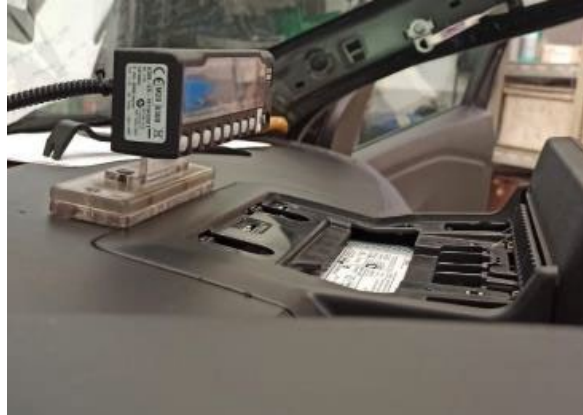
Fig. 5.3 Vista de la ubicación de taxímetro consola sobre salpicadero.
