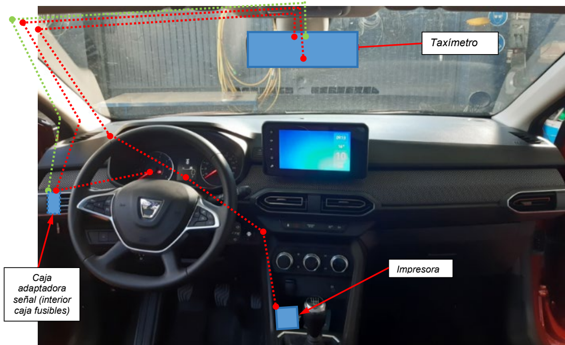
Fig. 4.5. Esquema orientativo del recorrido de las conexiones para taxímetros de espejo
