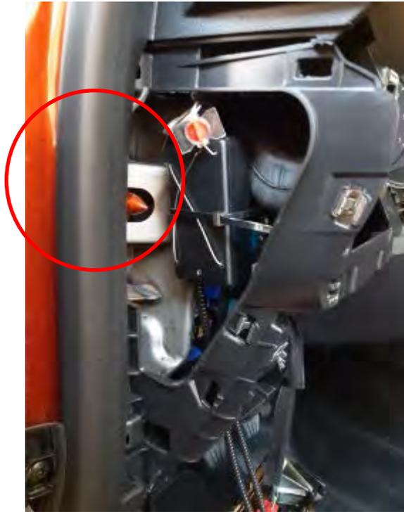
*Fig. 4.6. Zona de paso del cableado*
