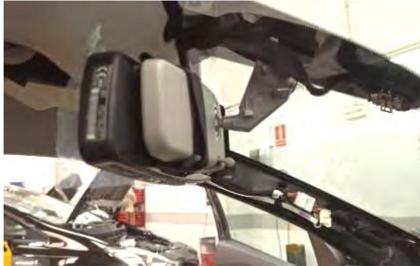
**Fig. 5.6.** Vista de taxímetro de espejo superpuesto.
