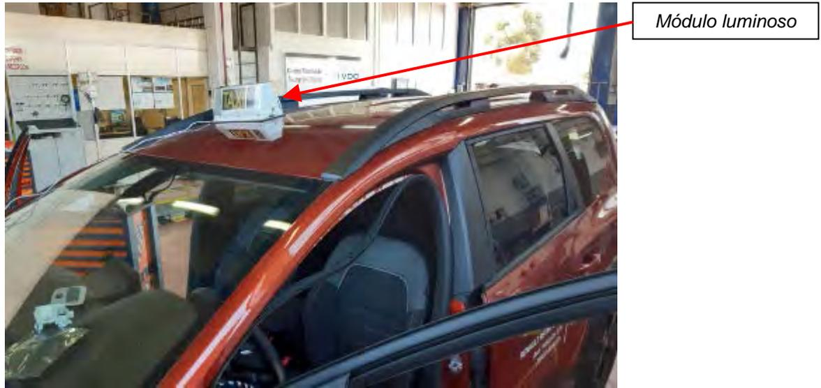
**Fig. 6.4.** Vista del módulo luminoso desplazado
