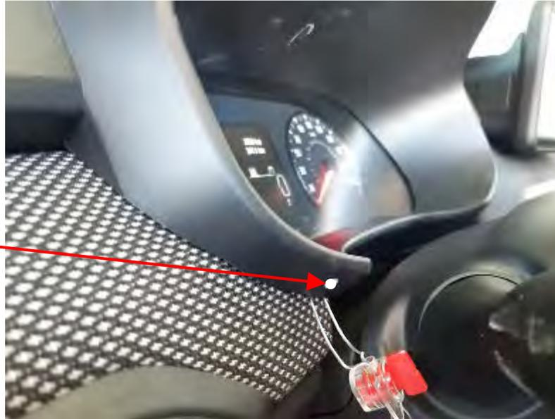
**Fig. 2.5.** Identificación de los taladros para el paso de alambre de precinto.
