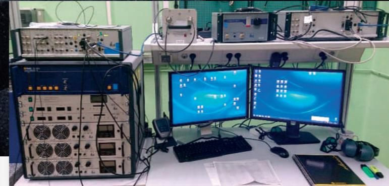
El análisis de vibraciones es uno de los métodos más efectivos para detectar el estado de la maquinaria ya que ayuda a la identificación de fallos y permite detectar desalineamientos en rodamientos, por ejemplo. La medida de vibración es una medida compleja que contiene diferentes parámetros, en el Laboratorio de vibraciones se realizan calibraciones primarias de acelerómetros por interferometría de acuerdo a la norma ISO 16063-11 en el rango de aceleración
