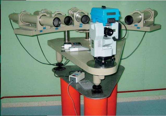
La instrumentación utilizada en los campos de la [topografía](#), [la ingeniería civil](#), [la cartografía](#) y [la geodesia](#) (miras ínvar, niveles y distanciómetros electrónicos, colimadores, teodolitos o estaciones totales), también es objeto de atención por parte del área.
