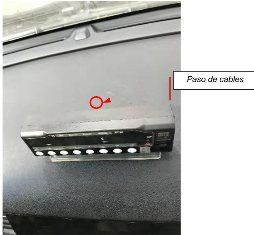
**Fig. 4.5.** Paso de cables para taxímetro de consola
