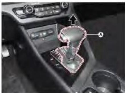
8. Desmonte la cubierta superior de la consola delantera (A) con un extractor.
