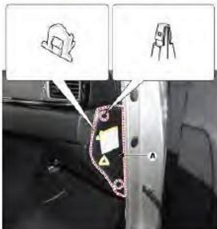
2. Desmonte la placa del panel de protección [RH] (A) con un extractor.
