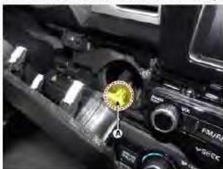
9. Desmonte el panel del tablero de instrumentos (A) con un extractor.
