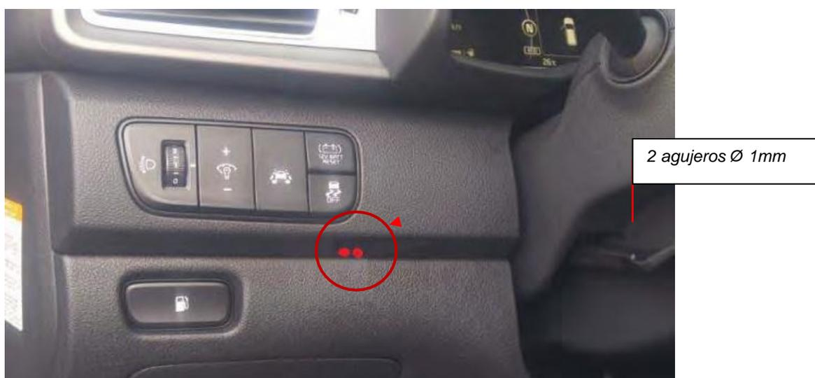
**Fig. 1.9.** Perforado del salpicadero para paso del alambre.
