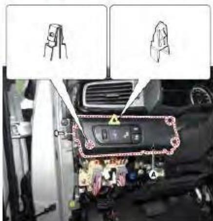
5. Desconecte el conector de la placa del panel de protección [LH] (A).
