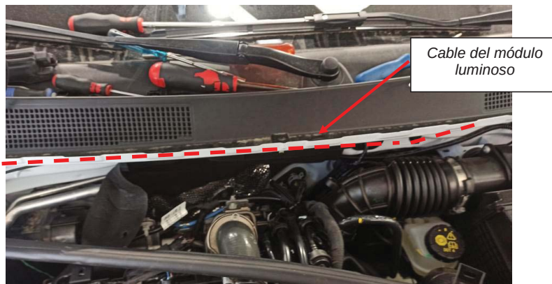
Fig. 6.6. Paso de cable por el compartimento motor
