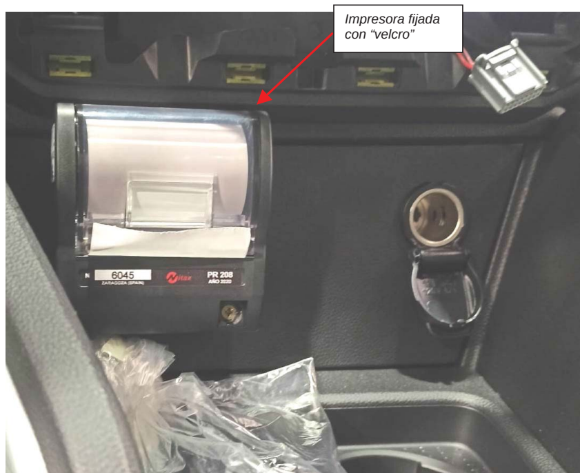
Fig. 5.1. Vista de la ubicación de impresora periférica.
