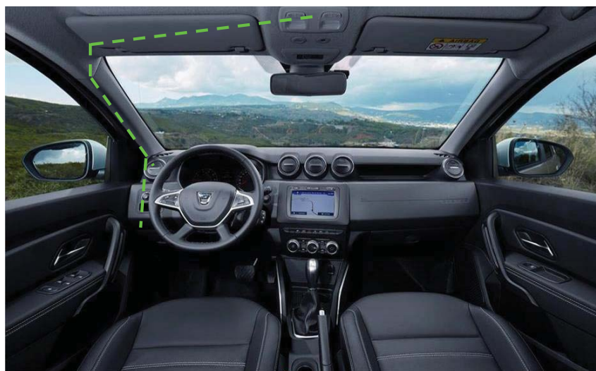
Fig. 6.10. Recorrido de cable del módulo centrado
