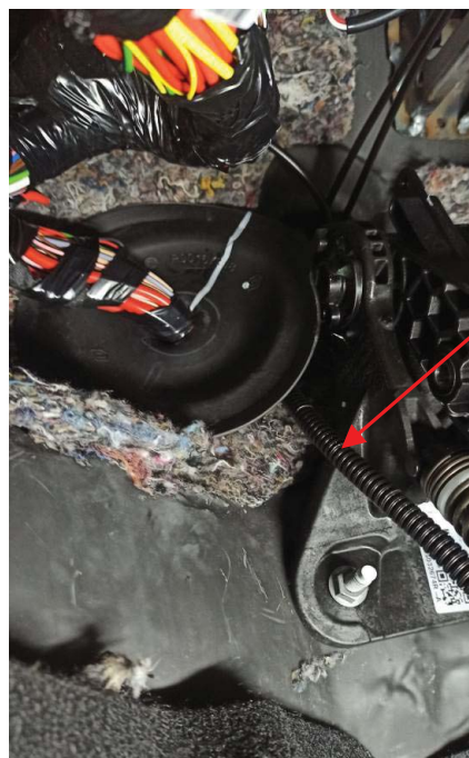
Fig. 4.2. Paso de manguera con cable de señal, vista habitáculo
