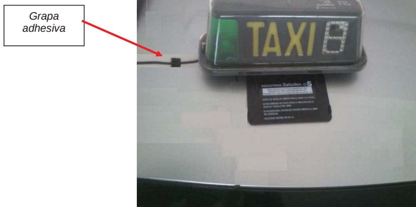
Fig. 6.4. Recorrido cable por el techo
