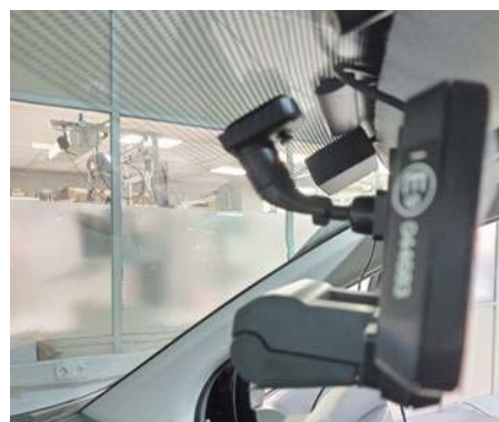
Fig. 4.8 y 4.9. Vistas del taxímetro de espejo con impresora sobre soporte propio.
