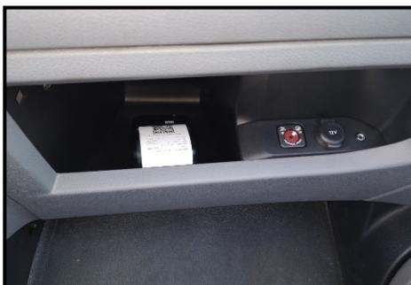
La impresora irá fijada mediante velcro adhesivo o bien mediante soporte suministrado por el fabricante, atornillado éste a la base la guantera (a elección del instalador).
