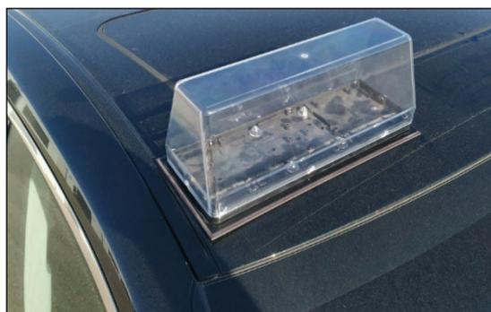
Ejemplos de capilla imantada con base magnética longitudinal y transversal
