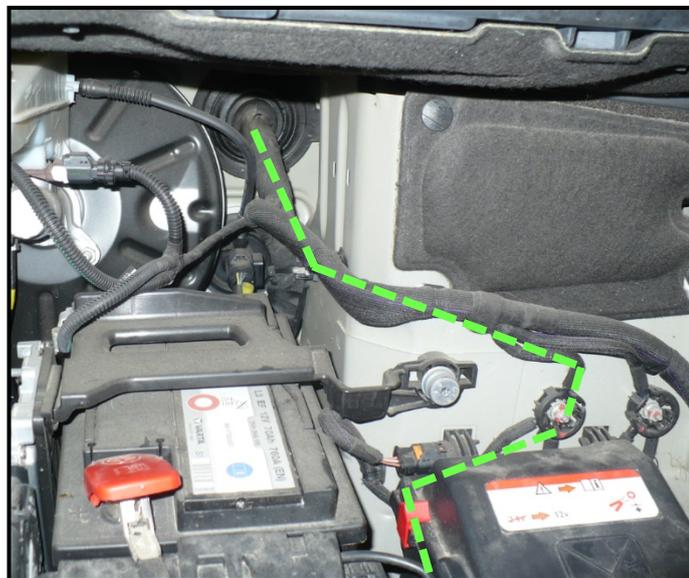
El +15 a través de contacto es opcional y lo podrá coger el instalador de aparatos taxímetros a su conveniencia, bien en la misma caja de fusibles del motor, bien en la caja de fusibles que está bajo el volante.
