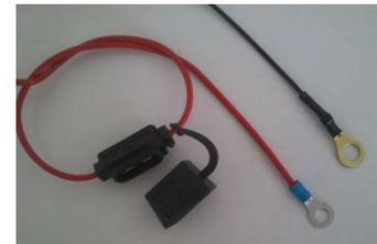
El +15 a través de contacto es opcional y lo podrá coger el instalador de aparatos taxímetros a su conveniencia, bien en la misma caja de fusibles del motor, bien en la caja de fusibles que está bajo el volante.
