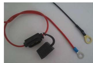
La alimentación eléctrica (+12V permanente) se tomará de la propia caja de fusibles de motor, en concreto de un borne que hay en su interior al cual se accede levantando una tapa de plástico negra.
