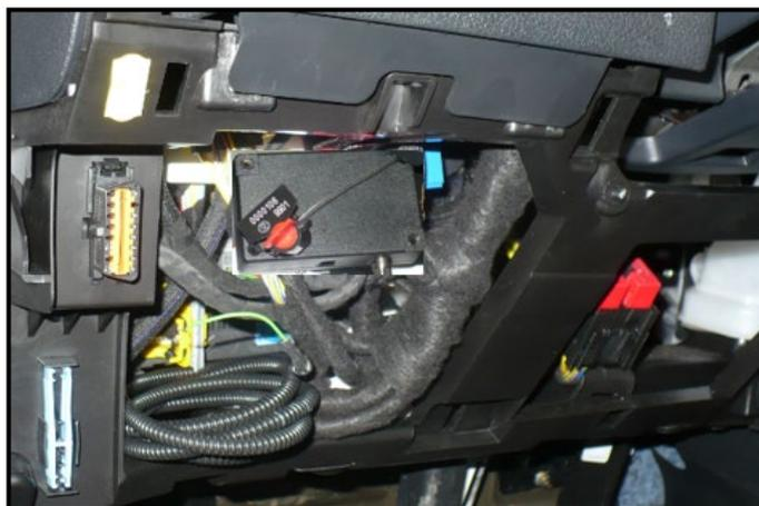
La manguera blindada sobrante se dejará enrollada en la zona bajo el volante a disposición del instalador del equipo taxímetro.
