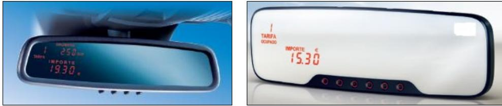
*Taxímetros de espejo sustitutos del espejo retrovisor interior original del vehículo deben disponer y ser compatibles con impresoras periféricas.*
