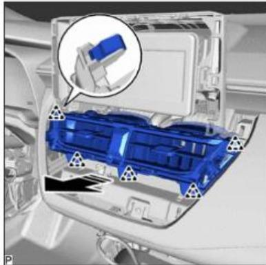
9 Extraer la parte derecha del panel de instrumentos.
