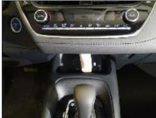
El cable de conexión se llevará por detrás del guarnecido del volante y bajará hasta la consola central. Se pasará el cable hasta el hueco de ubicación, y se perforará un orificio para que pasen los cables hasta la impresora.
