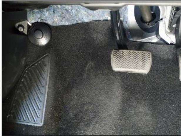
El conexionado se hará conforme a las instrucciones del fabricante del equipo, llevando el cable desde la ubicación del "pisón" en la zona izquierda del pedalier por el interior del salpicadero lado izquierdo junto a los cables de alimentación del taxímetro, hasta unirlo al resto de cableado del equipo taxímetro. Desde ahí seguir los pasos de los apartados II.1 y II.3 para el recorrido de los cables hasta el taxímetro y la capilla, y para el desmontaje de los guarnecidos necesarios.
