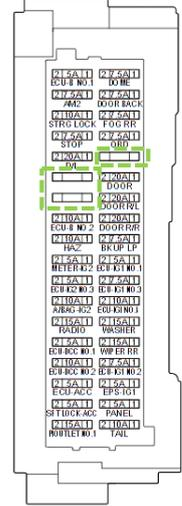
Si fuera necesario coger un positivo a través de contacto (bajo llave) puede hacerse en el fusible ECU ACC de 5A.
