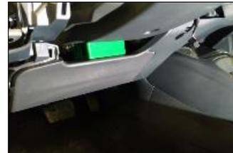
**Nota importante:** La ubicación indicada es la más idónea en base a la facilidad de acceso / inspección. No obstante, el instalador autorizado podrá reubicar la caja de conexiones en el área bajo el panel de instrumentos bien en la zona izquierda, o tras la guantera del lado derecho si por razones de cableados o conexiones no fuera posible instalarla bajo el volante, y siempre que no interfiera en los sistemas del vehículo (airbag, dirección, calefacción).
