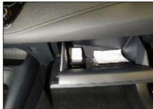
El cable de conexión se llevará por detrás del guarnecido del volante, bajará hasta la consola central, y se llevará por detrás de ésta hacia la derecha hasta la parte trasera de la bandeja de la guantera. Se perforará un orificio en la trasera de la bandeja de la guantera o bien se introducirán los cables por la parte superior hasta la impresora.
