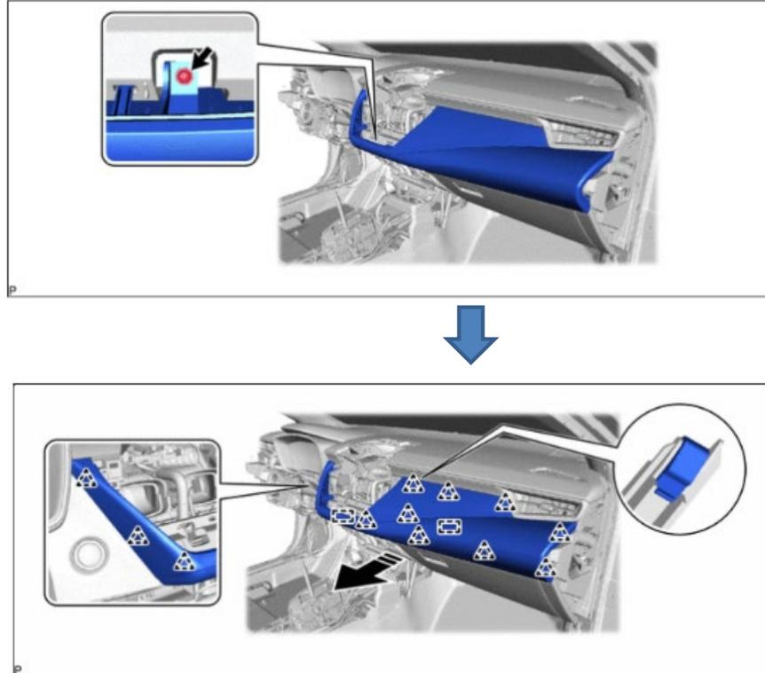
11 Extraer la cubierta de la columna de la dirección:
