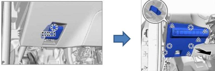
5 Extraer la moldura de acabado inferior del panel de instrumentos.
