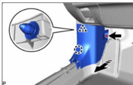
4. Extraer la cubierta de la guarnición de la abertura en la puerta delantera izquierda.
