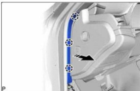
2. Extraer la parte izquierda del panel de instrumentos.
