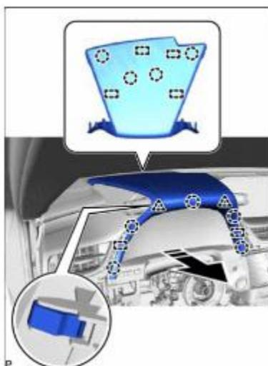
16. Extraer el conjunto superior de la moldura de acabado del panel de instrumentos.
