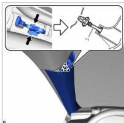
3. Desenganche las 2 guías para extraer el embellecedor del montante delantero izquierdo como se muestra en la ilustración
