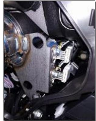
Como alternativa a la toma de alimentaciones en el conector G17 del cuadro de instrumentos, estas podrían tomarse de la caja de fusibles de habitáculo bajo volante mediante un conector de tipo fusible y de la manera que muestra la imagen:
