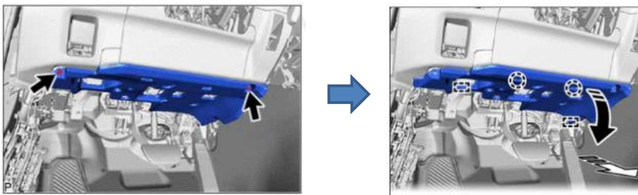
7. Extraer el conjunto inferior de la moldura del panel de instrumentos.
