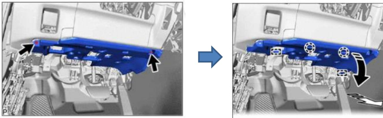
4. Extraer el conjunto inferior de la moldura del panel de instrumentos.
