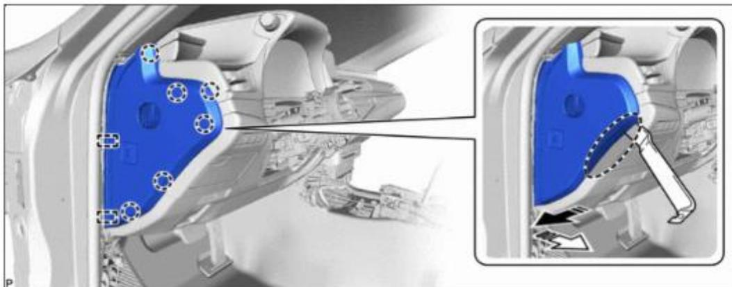
6. Extraer la cubierta inferior del panel de instrumentos N° 1.
