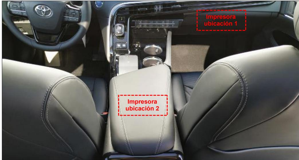
En cualquiera de estas ubicaciones, los cables de conexión necesarios para la impresora se llevarán por el interior de los guarnecidos, desde el punto de origen (caja de conexiones o conector cuadro de instrumentos) hasta dicha impresora.
