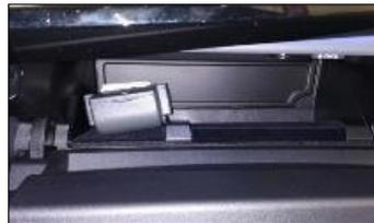
El cable de conexión se llevará por detrás del guarnecido del volante, bajará hasta la consola central, y se llevará por detrás de ésta hacia la derecha hasta el alojamiento tras la guantera. Los cables se pasarán por la tapa de registro del filtro del habitáculo, en el fondo de la guantera.
