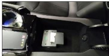
El cable de conexión se llevará desde el punto de origen hasta la consola central, y se llevará por el interior de la consola central hasta el cajón del apoyabrazos. Ahí se perforará un orificio en el frontal del cajón para pasar los cables hasta la impresora.
