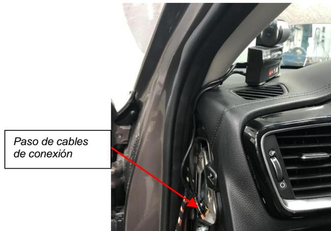
**Fig. 5.2.** Vistas de la conexión de la impresora.
