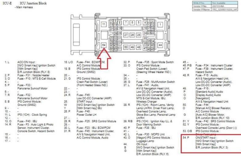
Fig. 2.4. Esquema de pins del connector ICU-E
