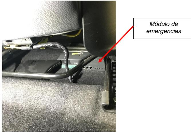
*Fig. 7.1. Vista del emplazamiento del módulo de emergencias.*
