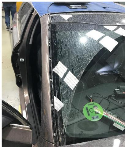
*Fig. 6.5. Recorrido del cable del m3dulo por el exterior del marco del prabrisas*
