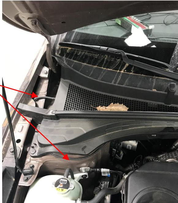
*Fig. 6.5. Paso del cable del módulo al compartimento motor*
