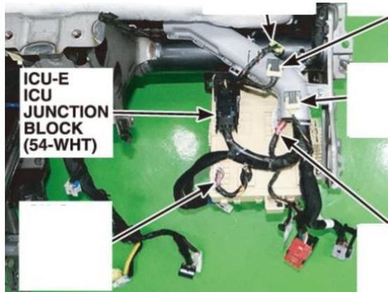
*Fig. 2.3. Vista posterior del conector ICU-E.*
