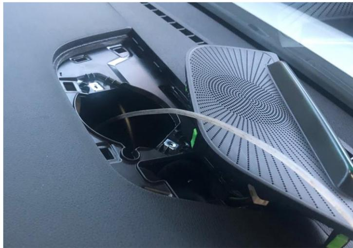
*Fig. 4.7. Paso de manguera al exterior del salpicadero*
