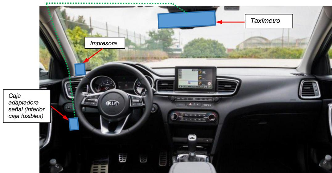
Fig. 4.1. Esquema orientativo de conexiones
