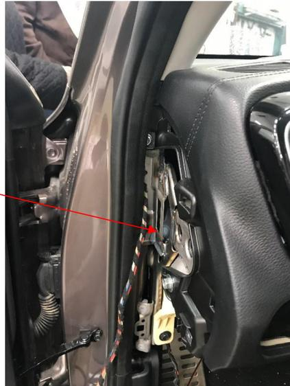
**Fig. 4.2.** Conexión del taxímetro con la caja adaptadora
