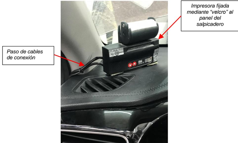
**Fig. 5.1.** Vistas de la disposición de la impresora.
