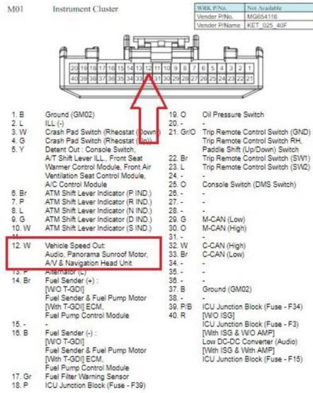
**Fig. 1.2.** Esquema de pines del conector M01
