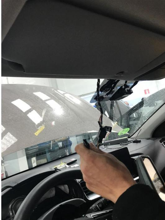
*Fig. 4.4. Salida de cables para taxímetro de espejo*
