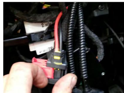
Una vez realizada la conexión de positivo con sus correspondientes fusibles, llevaremos un positivo y un negativo de batería hasta la caja adaptadora de señal situada en la zona de la BSI bajo volante lado conductor.
