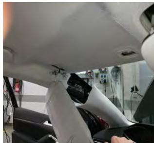
Pasamos el mazo del taxímetro por el montante lateral para brisas, teniendo en cuenta que el mazo no interfiera con el dispositivo de AIRBAG.
