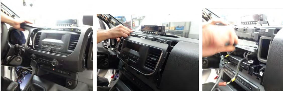
Pasaremos la manguera de conexión del taxímetro, desde el agujero del salpicadero, por la zona de ubicación de la radio, parte lateral, tal y como se muestra. Y a continuación lo llevaremos por el interior del cuadro de velocidad y lo llevaremos hasta la caja adaptadora de señal, situada en la parte de la BSI, bajo el volante.
