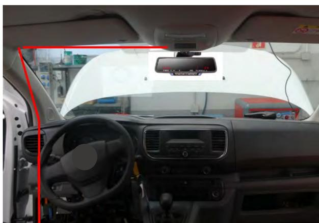
Desde el montante para brisas, se sacará la manguera de la impresora hacia el exterior del salpicadero en el caso 1, y en el caso 2, bajaremos la manguera entre la junta de puerta y el salpicadero hasta la impresora.
