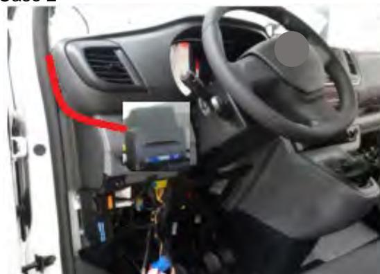
Para los taxímetros de espejo, los cables de conexión con la impresora irán encaminados por dentro del guarnecido de techo, y del guarnecido lateral de parabrisas del lado izquierdo, y de ahí hasta la impresora.
