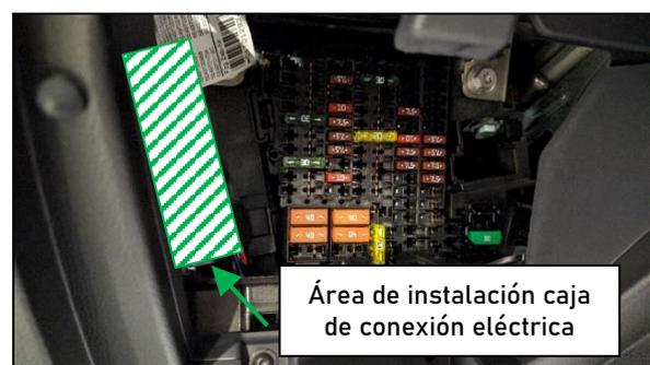
Figura 4. Área de instalación caja conexión eléctrica.
