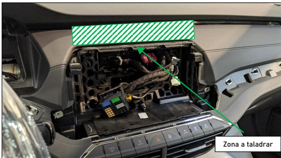
Figura 22. Zona a taladrar para el paso de mangueras.
