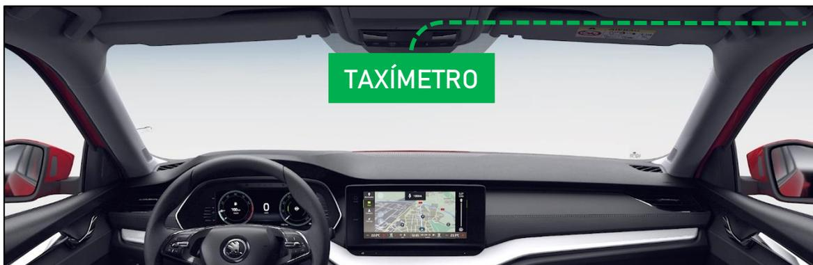
Figura 31. Trazado del cable del módulo tarifario
