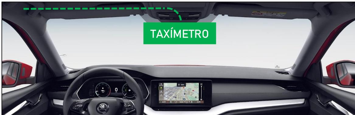
Figura 30. Trazado del cable del módulo tarifario
