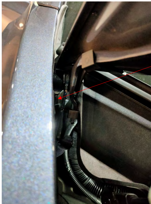
Paso del cable del módulo
