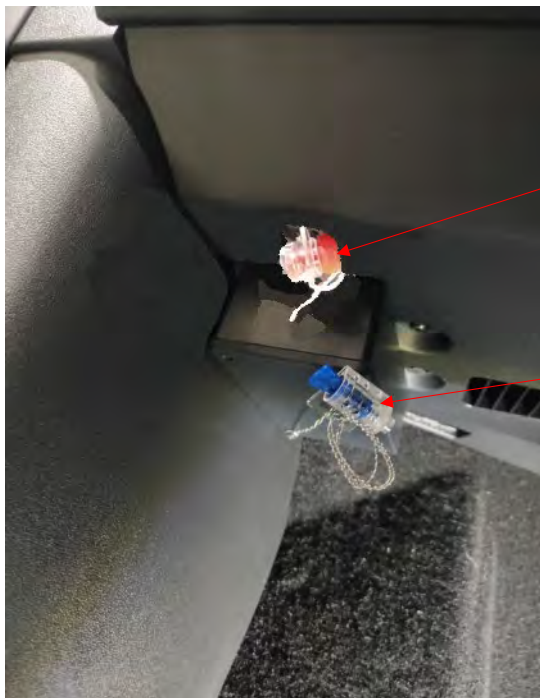
Vista del montaje final de la caja de conexiones precintada
