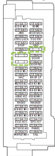
Si fuera necesario coger un positivo a través de contacto (bajo llave) puede hacerse en el fusible ECU ACC de 5A.
