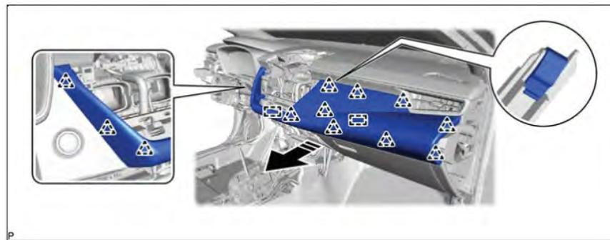
11 Extraer la cubierta de la columna de la dirección:
