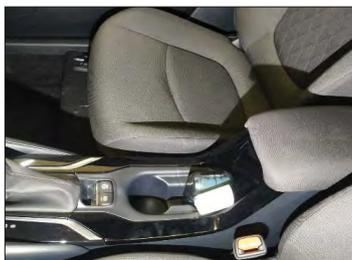
El cable de conexión se llevará desde el punto de origen hasta la consola central, y se llevará por el interior de la consola central hasta el hueco del posavasos. Ahí se perforará un orificio para pasar los cables hasta la impresora.
