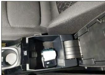
El cable de conexión se llevará desde el punto de origen hasta la consola central, y se llevará por el interior de la consola central hasta el cajón del apoyabrazos. Ahí se perforará un orificio en el cajón junto a la toma de 12V para pasar los cables hasta la impresora.
