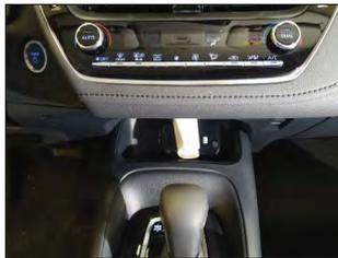
El cable de conexión se llevará por detrás del guarnecido del volante y bajará hasta la consola central. Se pasará el cable hasta el hueco de ubicación, y se perforará un orificio para que pasen los cables hasta la impresora.
