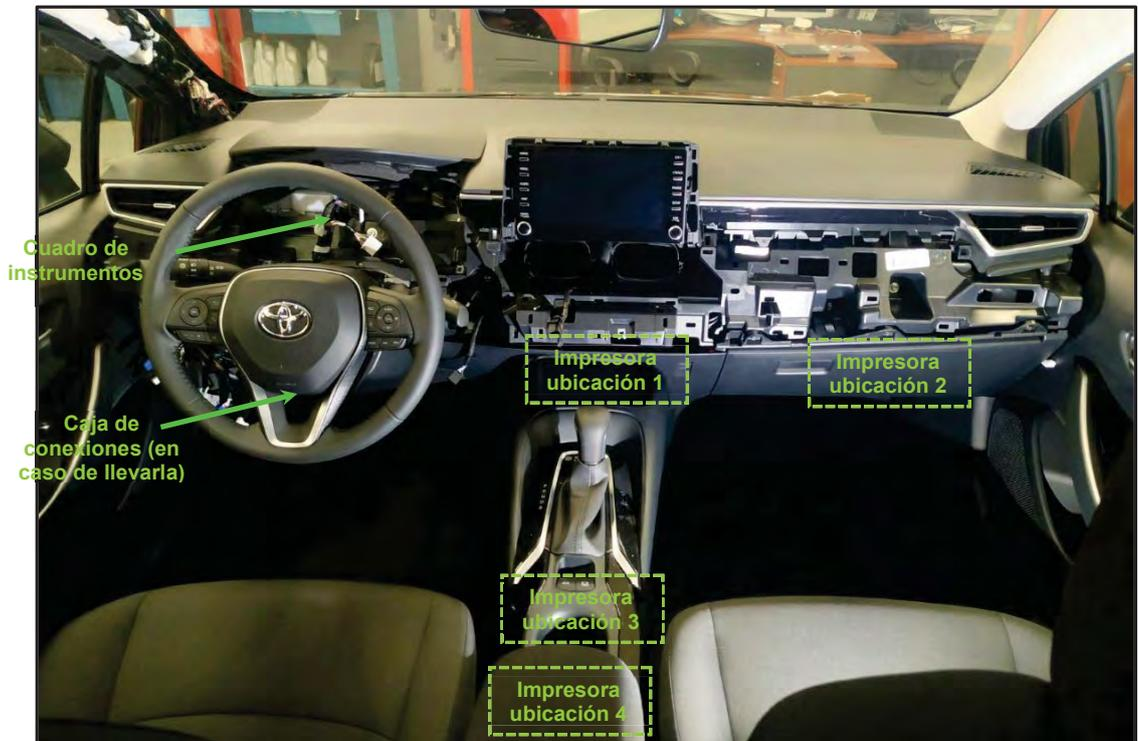
En cualquiera de estas ubicaciones, los cables de conexión necesarios para la impresora se llevarán por el interior de los guarnecidos, desde el punto de origen (caja de conexiones o conector cuadro de instrumentos) hasta dicha impresora.
