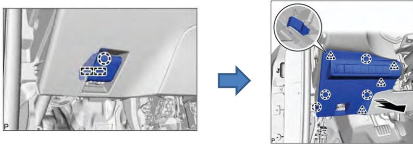
5 Extraer la moldura de acabado inferior del panel de instrumentos.
