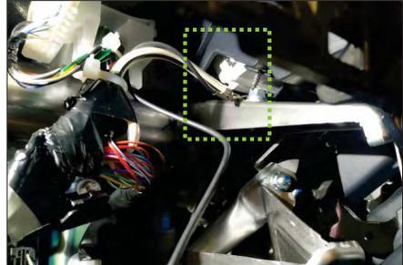
La alimentación eléctrica (positivo directo y positivo bajo llave) se tomará de la caja de fusibles del interior bajo el panel de instrumentos, usando los huecos vacíos disponibles en dicha caja y colocando en cada alimentación su correspondiente fusible doble de la manera que muestra la imagen:
