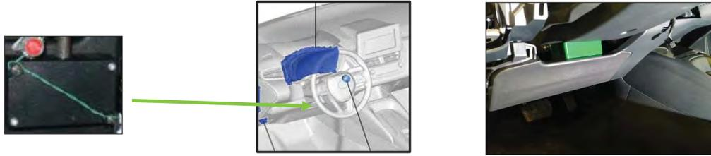
**Nota importante:** La ubicación indicada es la más idónea en base a la facilidad de acceso / inspección. No obstante, el instalador autorizado podrá reubicar la caja de conexiones en el área bajo el panel de instrumentos bien en la zona izquierda, o tras la guantera del lado derecho si por razones de cableados o conexiones no fuera posible instalarla bajo el volante, y siempre que no interfiera en los sistemas del vehículo (airbag, dirección, calefacción).
