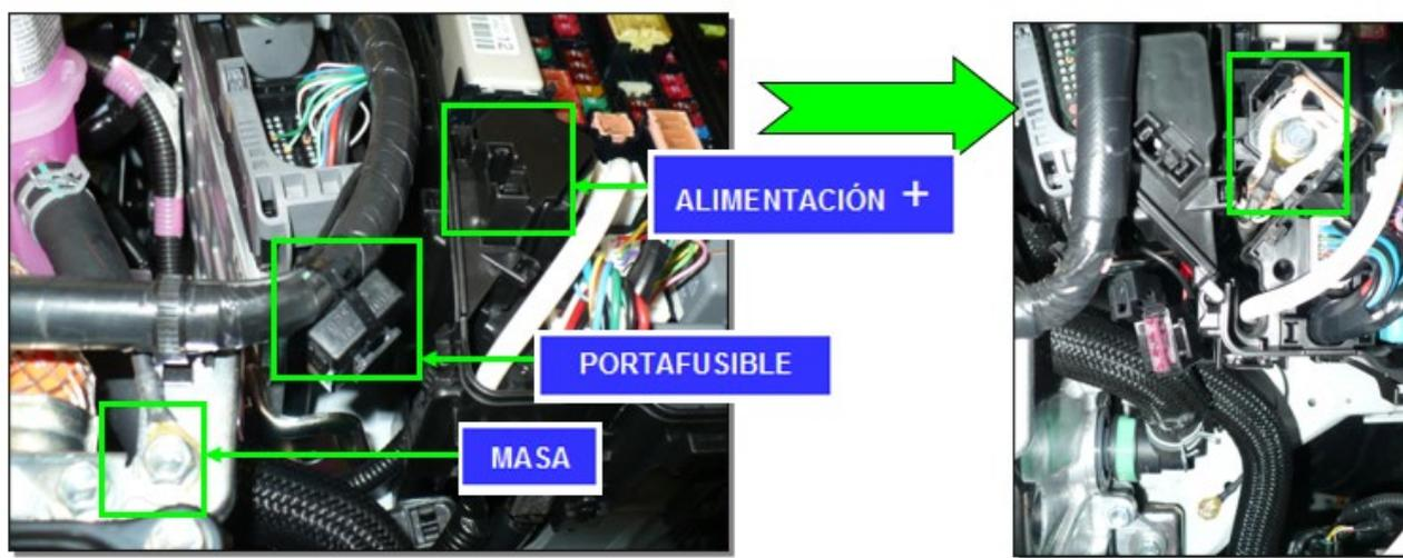
En caso de tener que montar caja de conexiones eléctricas (alimentación de taxímetro, capilla, etc), dicha caja irá instalada junto a la caja de señales (ubicada en la tapa de fusibles), fijada mediante tornillos y precintada.
