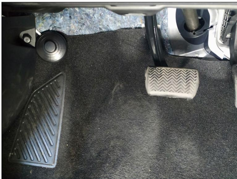
El conexionado se hará conforme a las instrucciones del fabricante del equipo, llevando el cable desde la ubicación del "pisón" en la zona izquierda del pedalier por el interior del salpicadero lado izquierdo junto a los cables de alimentación del taxímetro, hasta unirlo al resto de cableado del equipo taxímetro. Desde ahí seguir los pasos de los apartados II.A, II.B y II.D para el recorrido de los cables hasta el taxímetro y la capilla, y para el desmontaje de los guarnecidos necesarios.
