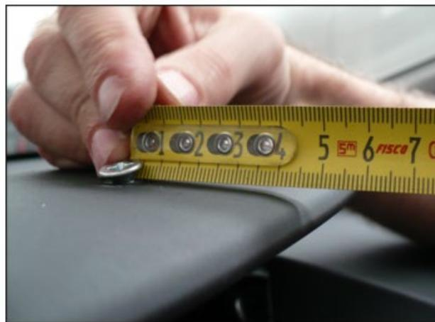
El soporte irá fijado con tornillos rosca-chapa y la distancia entre ambos variará en función del modelo de taxímetro.
