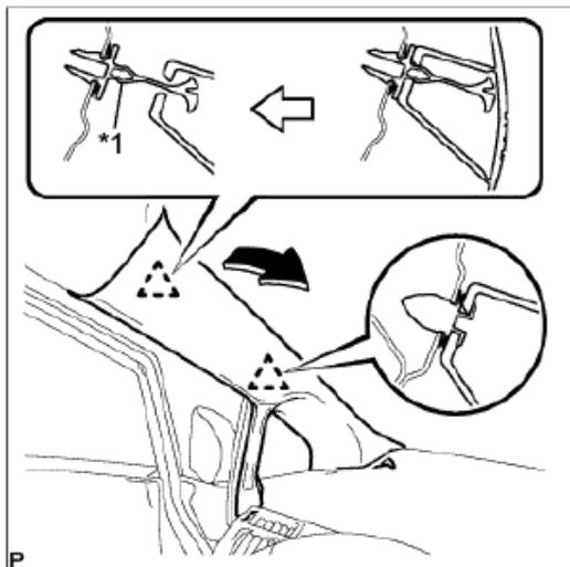
2. Utilizando unos alicantes de punta, girar los clips 90º y sacarlos de la moldura. Sacar la moldura de sus guías y tirar en la dirección de la flecha.
