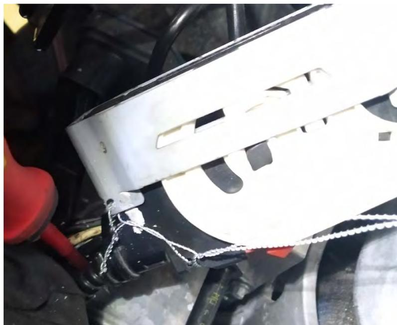
*Fig. 2.5. Precintado del conector. Detalle de la colocación del alambre*
