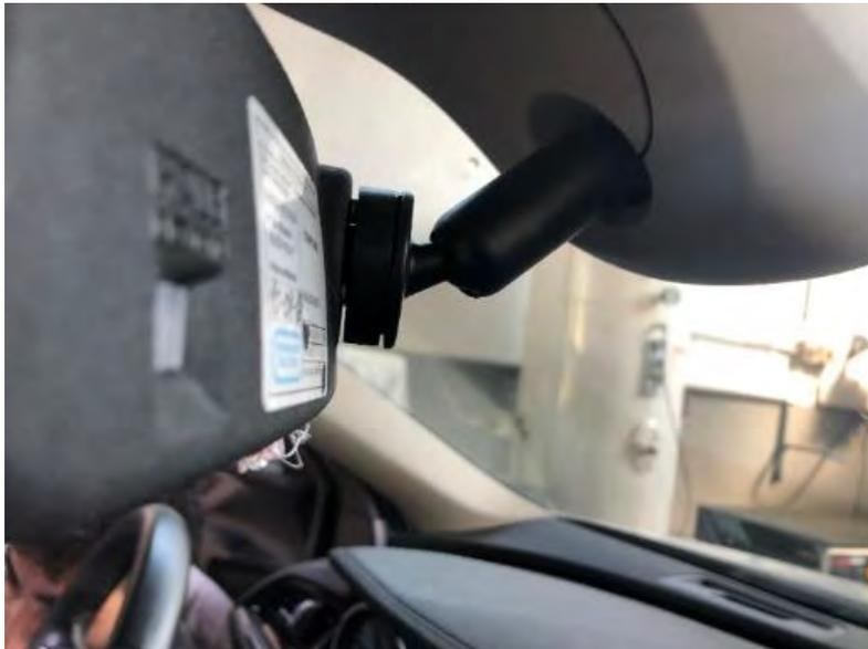
*Fig. 4.2 y 4.3. Vistas de la disposición del taxímetro de espejo.*
