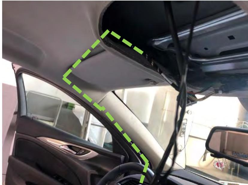
*Fig. 4.4. Recorrido del cableado para el taxímetro de espejo.*
