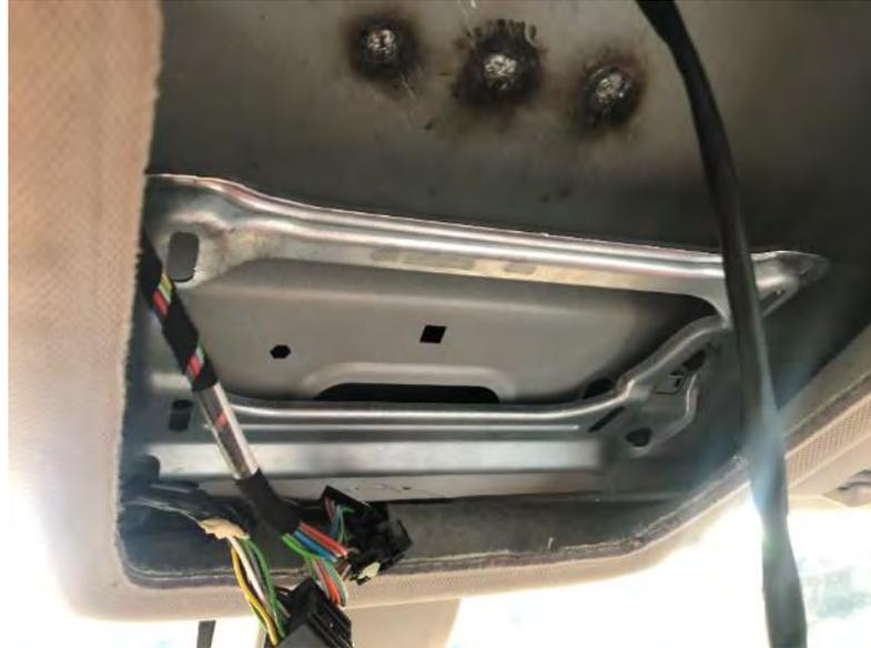
**Fig. 6.3.** Vistas del plafón superior desmontado para la ubicación para los taladros
