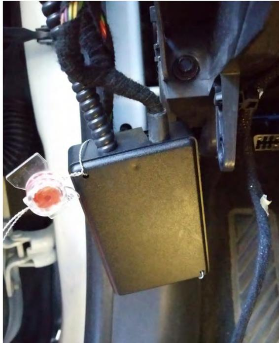
**Fig. 3.4.** *Vistas de la caja de conexiones y detalle de los precintos*
