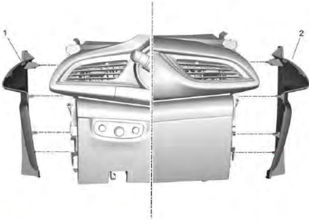
3. Cubierta de revestimiento exterior del panel de instrumentos — (1 - 2) » Desmontar — [Sustitución de la tapa de revestimiento exterior del panel de instrumentos](#)
