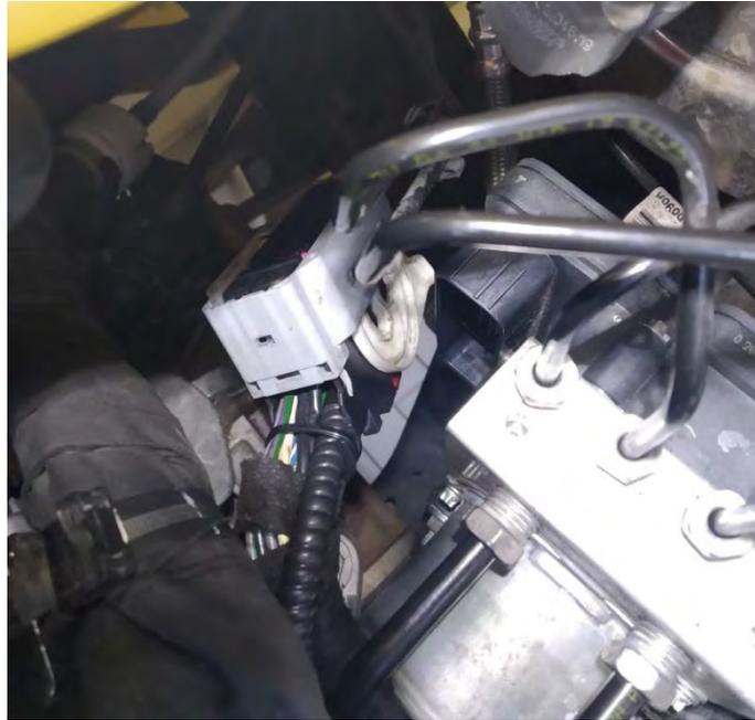
*Fig. 2.4. Conexión de la manguera blindada con el conector*
