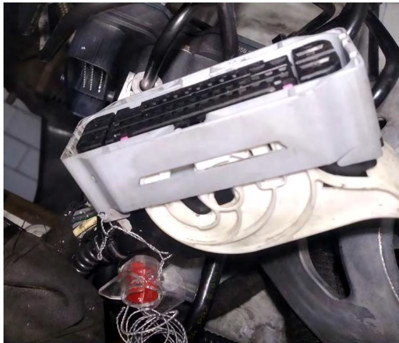
*Fig. 2.7. Precintado del conector. Colocación del precinto*
