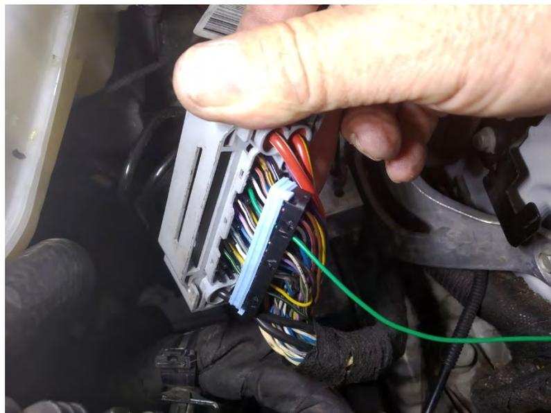
*Fig. 2.3. Vista de la conexión del cable de señal para taxímetro*
