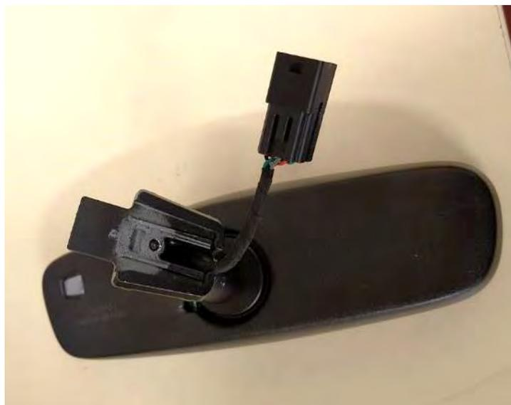
**Fig. 4.7, 4.8 y 4.9.** Desmontaje del retrovisor interior
