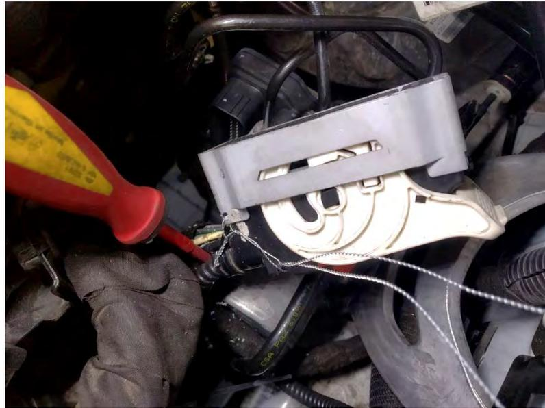
*Fig. 2.6. Precintado del conector. Colocación del alambre, vista general*
