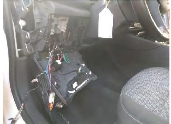
*Fig. 3.1 y 3.2. Desmontaje panel lateral salpicadero y tapa caja fusibles*
