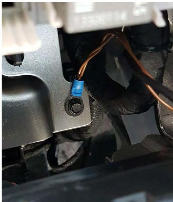
*Fig. 3.6. Vista de las conexiones de alimentación: masa*
