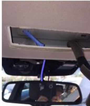
\*La luz interior del techo se pueden desmontar sin la necesidad de ninguna herramienta especial ya que va fijada con clips y grapas.
