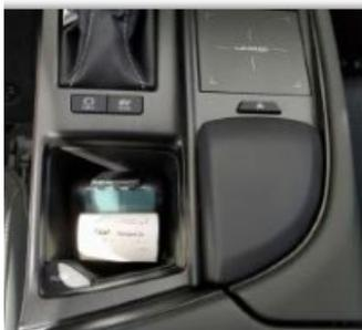
El cable de conexión se llevará desde el punto de origen hasta la consola central, y se llevará por el interior de la consola central hasta el hueco del posavasos. Ahí se perforará un orificio para pasar los cables hasta la impresora.
