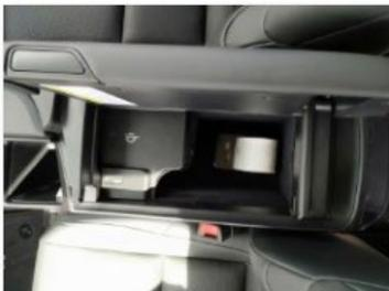
El cable de conexión se llevará desde el punto de origen hasta la consola central, y se llevará por el interior de la consola central hasta el cajón del apoyabrazos. Ahí se perforará un orificio en el cajón bajo la base de carga inalámbrica para pasar los cables hasta la impresora.
