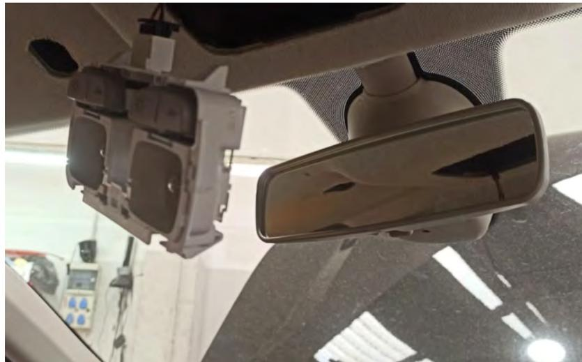
*Fig. 5.4. Vista del plafón desmontado y del retrovisor original.*
