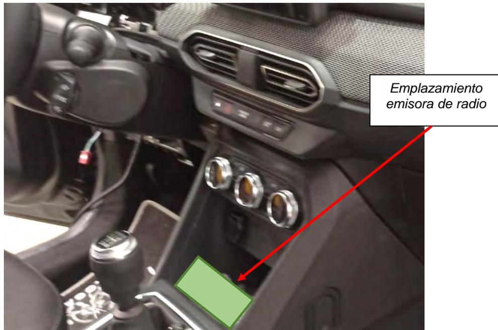
*Fig. 7.5. Vista del emplazamiento de la emisora.*
