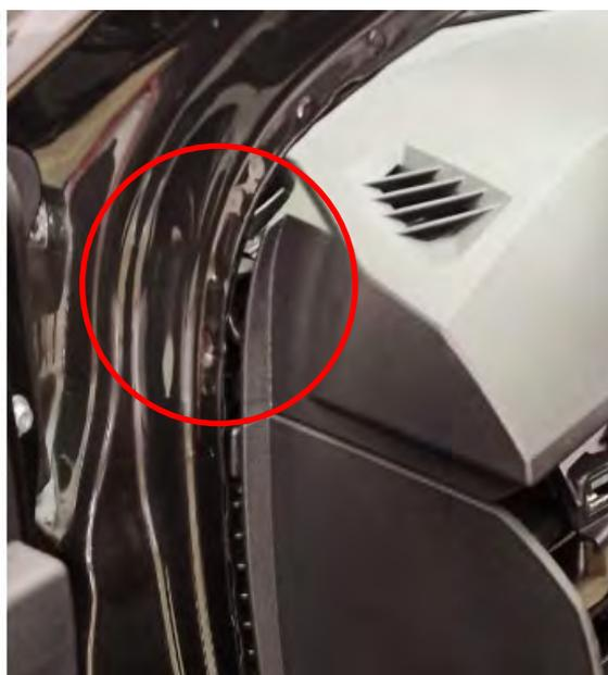
**Fig. 4.5.** Zona de paso del cableado
