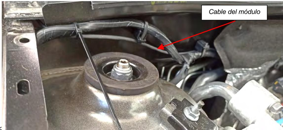
*Fig. 6.6 Vista del recorrido del cable módulo luminoso por el cofre motor*
