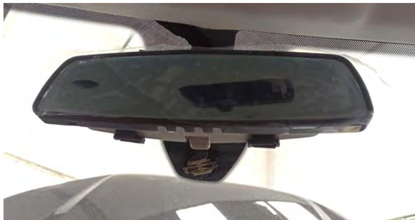
*Fig. 5.5. Vista del taxímetro de espejo*
