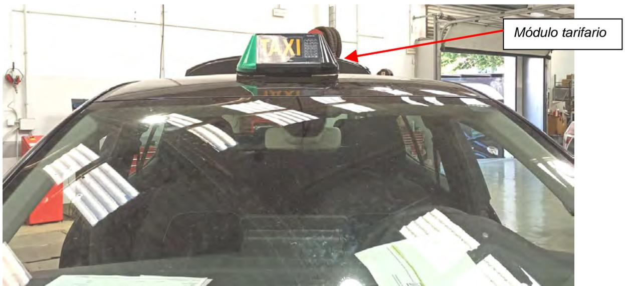
**Fig. 6.1.** Vista frontal ejemplo módulo centrado atornillado
