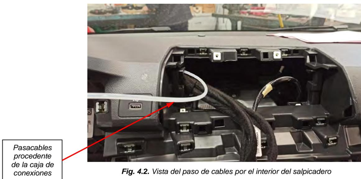
**Fig. 4.2.** Vista del paso de cables por el interior del salpicadero
