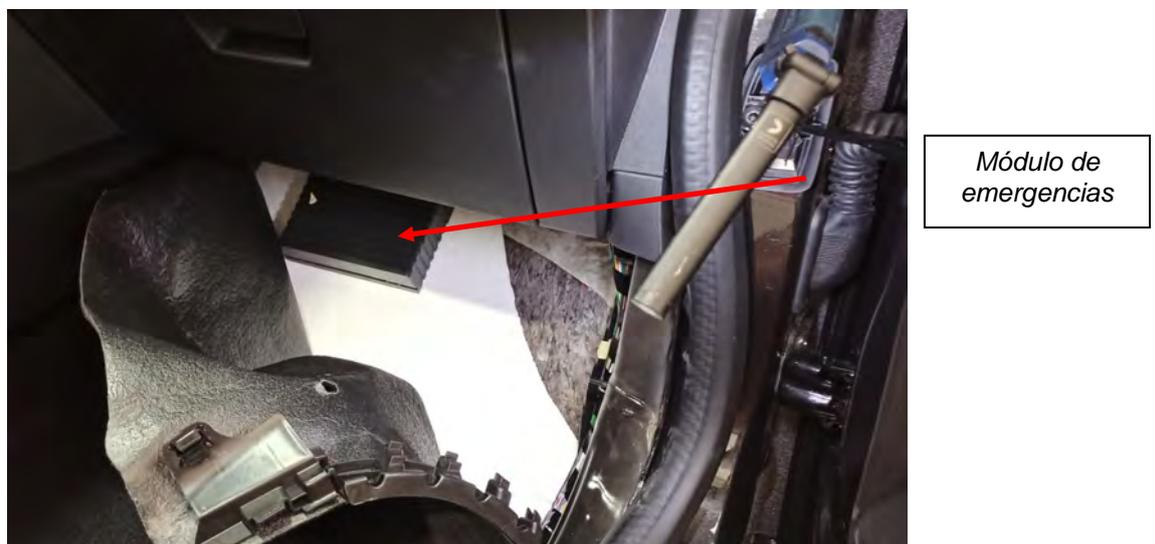
**Fig. 7.2.** Vista del emplazamiento del módulo de emergencias bajo el guarnecido.
