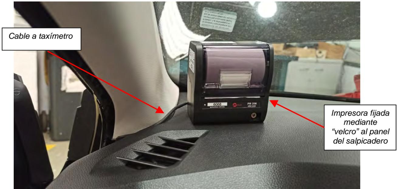
*Fig. 5.7 Vistas de la disposición de la impresora.*
