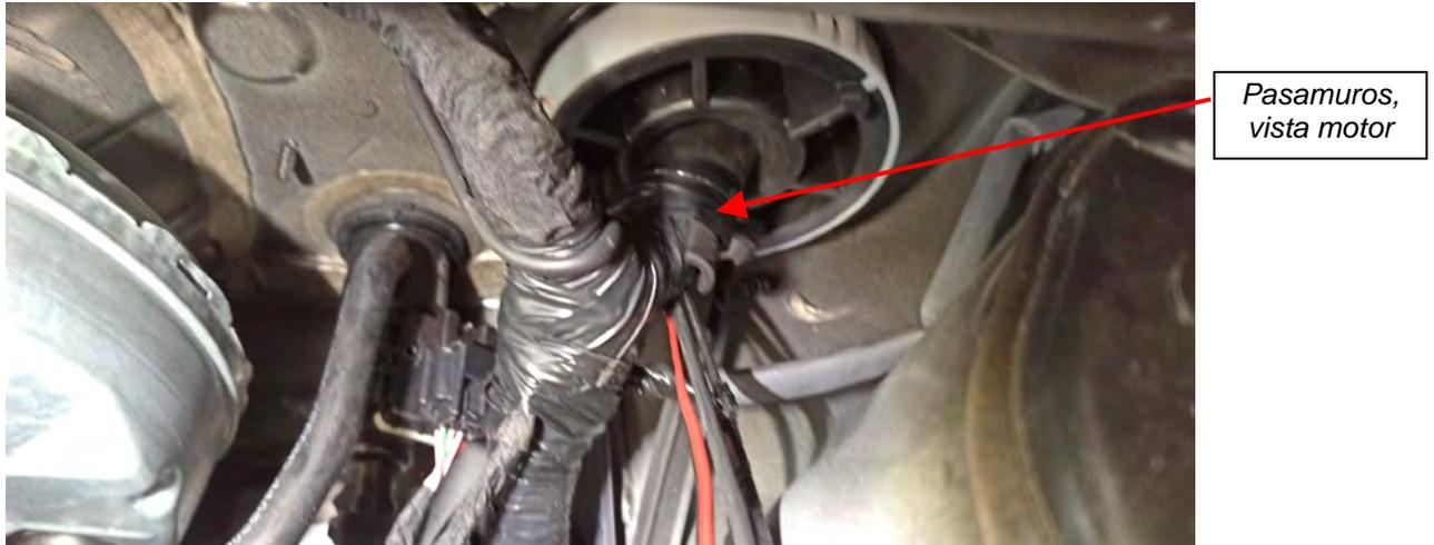
*Fig. 2.2. Detalle pasamuros, vista compartimento motor*
