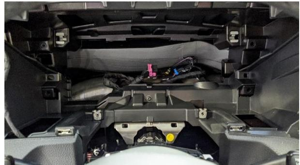
Figura 7. Cuadro de instrumentos desmontado.
