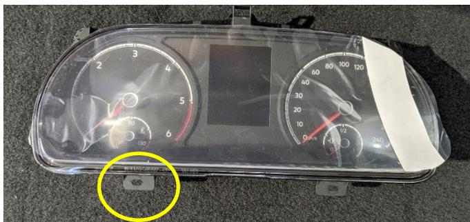
Figura 14. Ubicación tornillo a sustituir.
