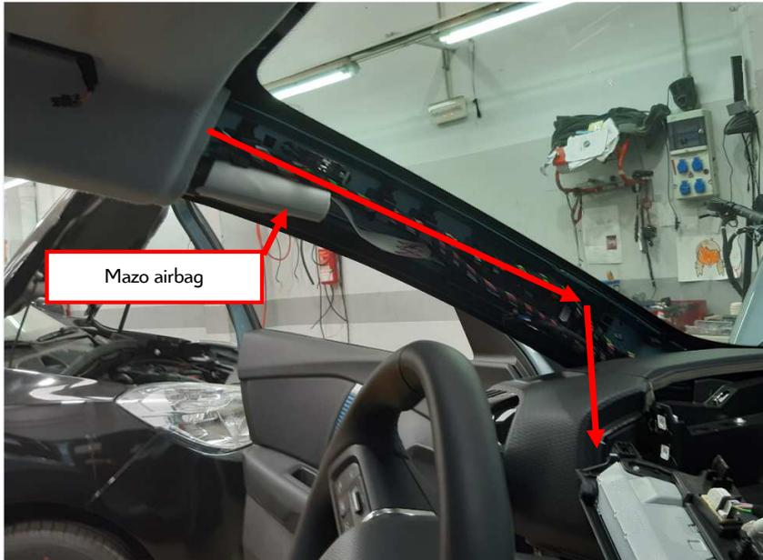
Al pasar el mazo debemos prestar atención para que quede por encima del Airbag lateral situado por el interior del guarnecido de techo, para garantizar que, en caso de funcionamiento del airbag, el mazo del taxímetro de espejo no va a interferir al despliegue del mismo.
