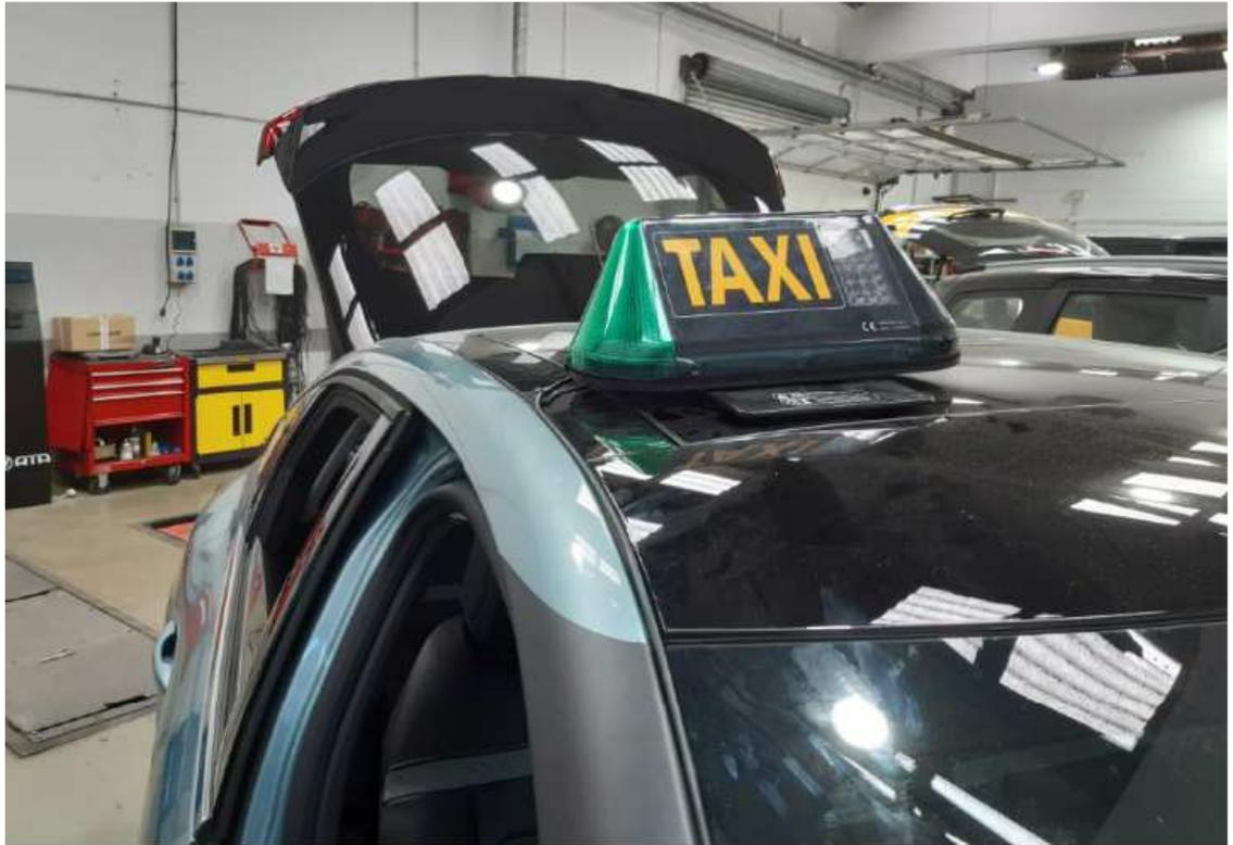
Una vez situado el módulo tarifario sobre el techo , encaminamos el cable de alimentación del módulo , por el vierte aguas derecho (en sentido conductor).
