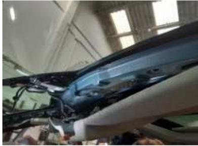
Centramos el módulo , y realizamos los 3 taladros para el cable y las fijaciones (dos de anclaje de 7mm diámetro, y uno para el mazo eléctrico de 16 mm diámetro)
