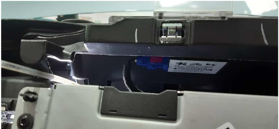
Una vez realizado el taladro se procederá a pasar la guía pasa cables para encaminar las diferentes conexiones hasta la caja adaptadora de señal.
