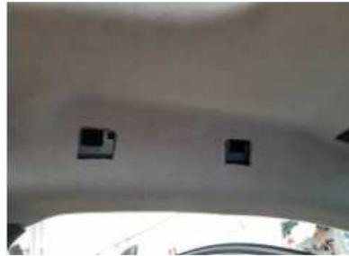
Desmontamos el guarnecido lateral izquierdo del montante para brisas, y el parasol del lado conductor, para encaminar el mazo del aparato taxímetro por el interior del mismo.
