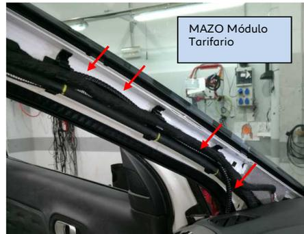
**ATENCIÓN: El mazo del taxímetro de espejo debe ir por encima del airbag lateral.**
