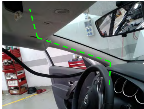
Fig. 8.8. Vista recorrido del cable del módulo
