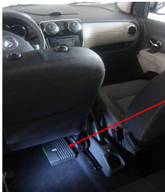
Fig. 9.1. Vista del emplazamiento del módulo de emergencias.
