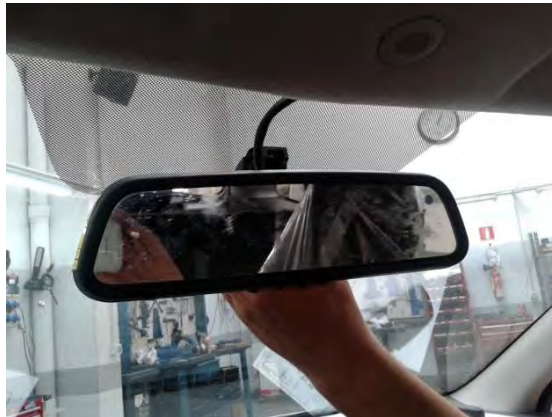
Fig. 6.2. Vista del taxímetro de espejo sobre soporte original del vehículo
