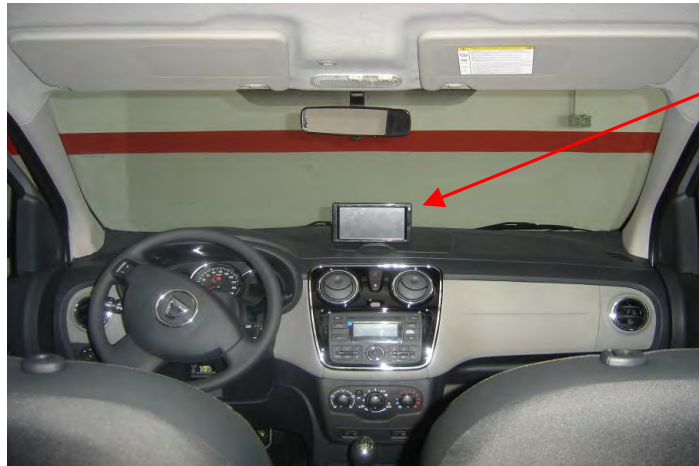
Fig. 5.4. Vista de la disposición del taxímetro con impresora integrada
