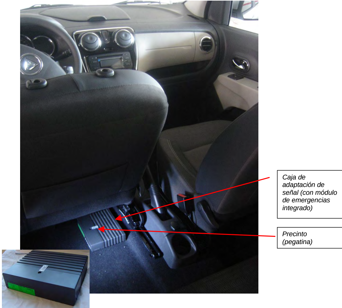
Fig. 3.5. Vistas de la caja adaptadora de señal con módulo de emergencias integrado.
