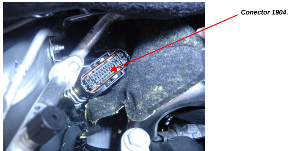
Fig. 2.2. Vista detalle del conector extraído.
