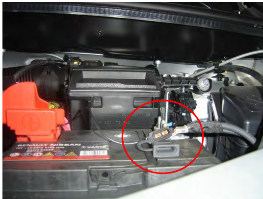
Fig. 4.1. Vista del fusible exterior
