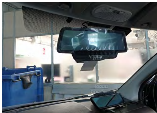
Fig. 6.3 y 6.4. Vistas del taxímetro de espejo con impresora sobre soporte propio.
