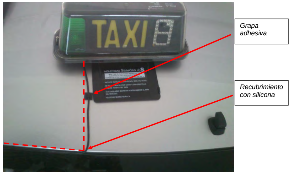
Fig. 8.3. Vista módulo fijado mediante placa imantada
