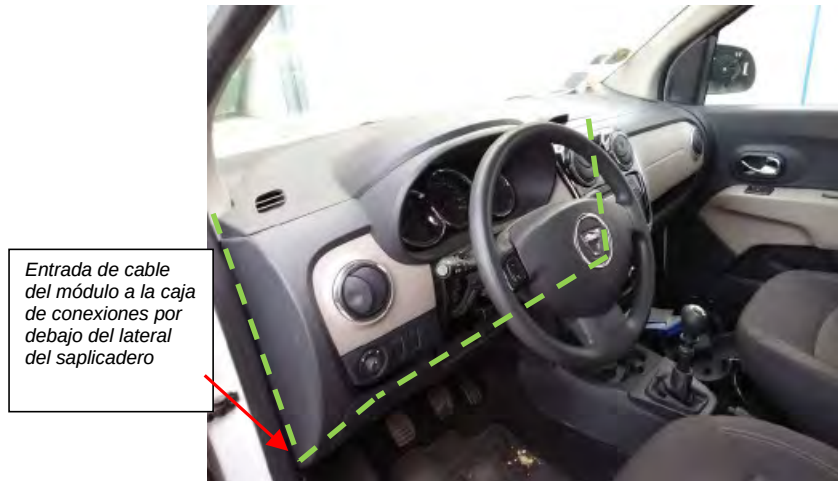
Fig. 8.9. Vista paso del cable del módulo a la caja de conexiones
