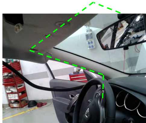
Fig. 6.3. Vista recorrido del cable del taxímetro de espejo y la caja adaptadora de señal
