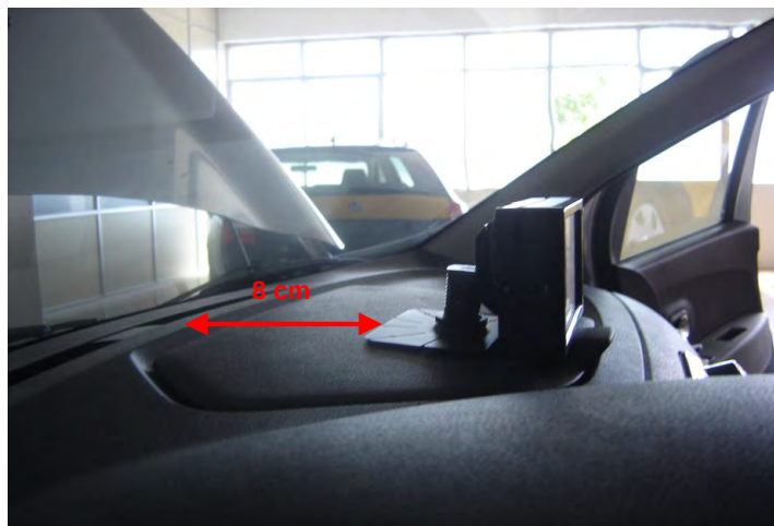
Fig. 5.5. Vista de la disposición del taxímetro con cota referenciada al borde trasero de la guantera.
