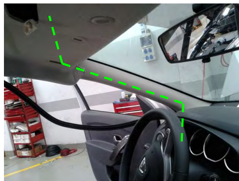
Fig. 8.8. Vista recorrido del cable del módulo
