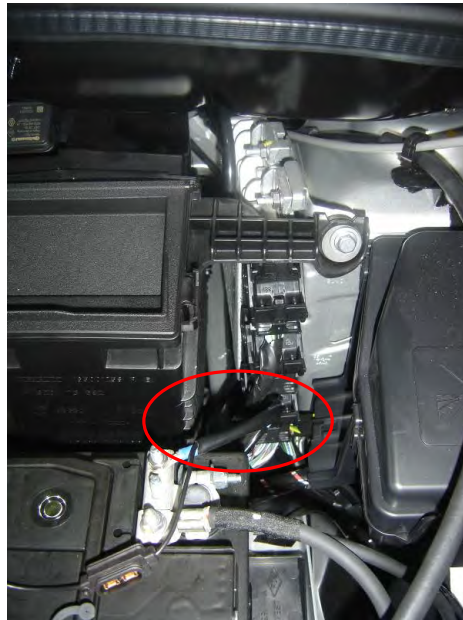
Fig. 4.2. Vista del cable con el fusible exterior incorporado hacia el pasamuros.
