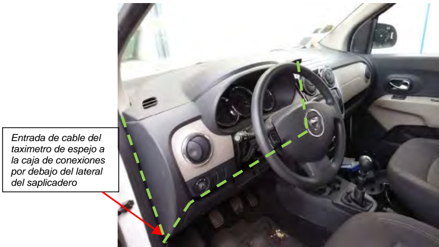
Fig. 6.4. Vista recorrido del cableado entre el módulo y la caja adaptadora de señal
