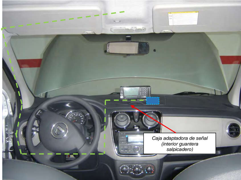
Fig. 8.7. Recorrido de las conexiones para el módulo centrado atornillado
