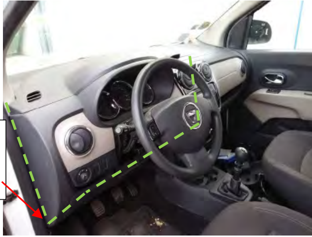
Fig. 8.9. Vista paso del cable del módulo a la caja de conexiones
