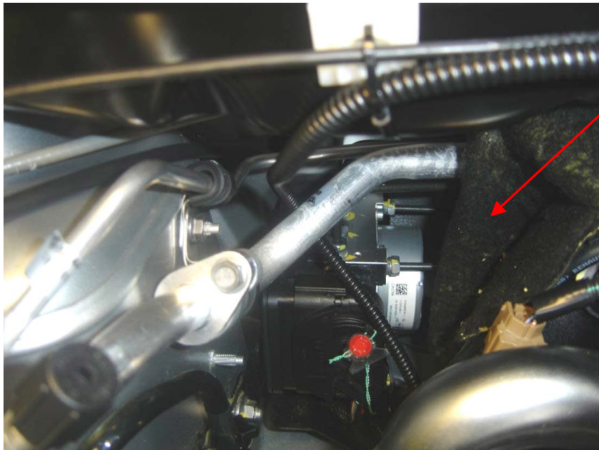
Fig. 3.4. Vista de la disposición del cable de precintado, tras la manta del módulo ABS/ESP.
