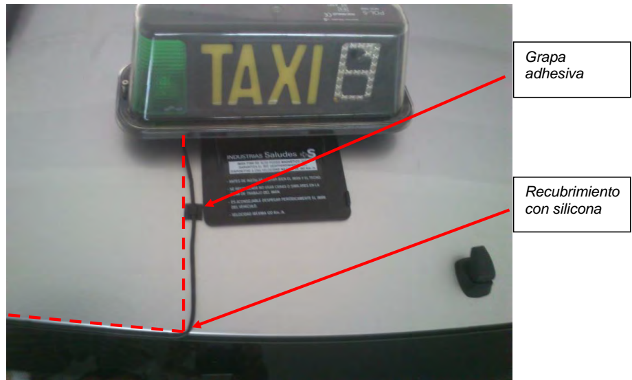
Fig. 8.3. Vista módulo fijado mediante placa imantada
