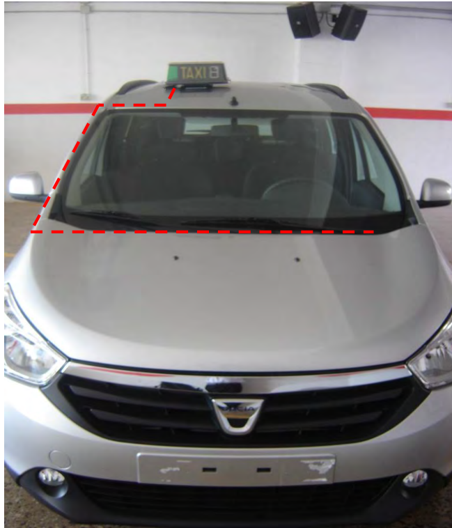
Fig. 8.4. Vista módulo fijado mediante placa imantada
