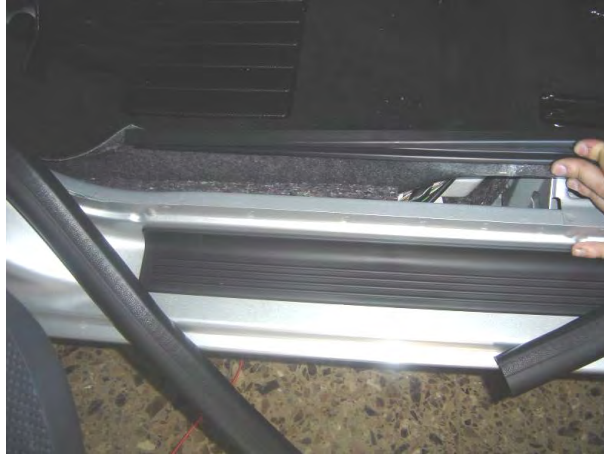
Fig. 9.3. Vista del recorrido de las conexiones del módulo de emergencias.
