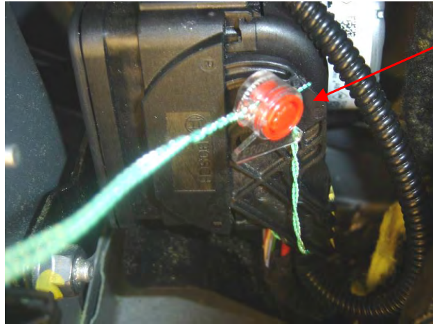
Fig. 3.3. Vista de la disposición del cable de precintado del conector
