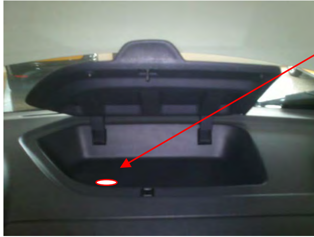
Fig. 4.3. Vista del paso de cables correspondiente a la toma de señal, Guanterera.
