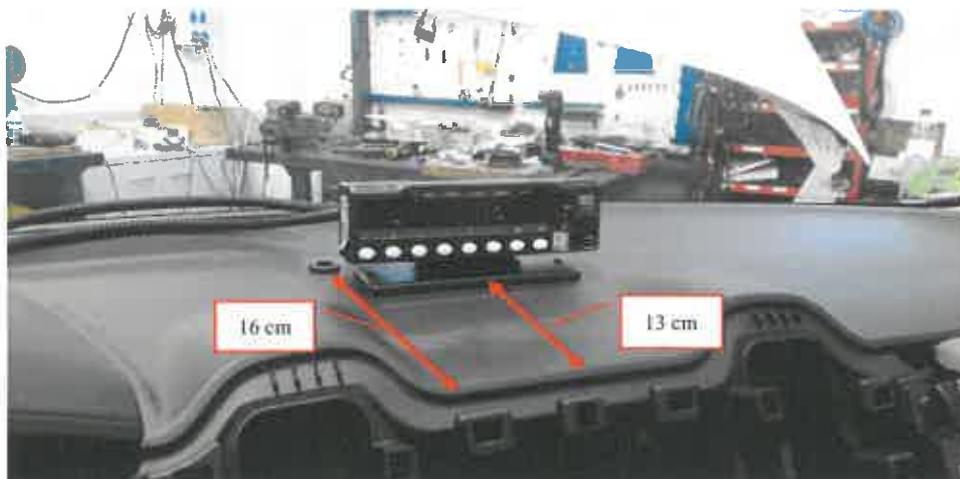
Llevaremos la guía pasacables desde el taladro hasta la zona de emplazamiento de la caja adaptadora por el interior del salpicadero, para proceder a encaminar las mangueras de cables que deben ir hasta el taxímetro (Señal de velocidad, alimentación y señal de la caja adaptadora, módulo tarifario).
