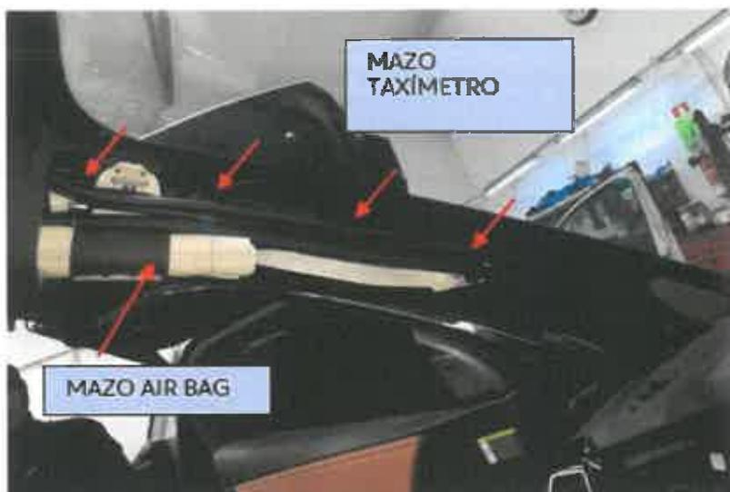
Finalmente, el mazo completo del taxímetro se lleva hasta la BSI por el lateral del salpicadero, donde se conectará con la caja adaptadora de señal del instalador, con su precinto correspondiente.
