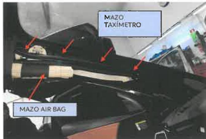
**ATENCIÓN: El mazo del taxímetro de espejo debe ir por encima del airbag lateral.**
