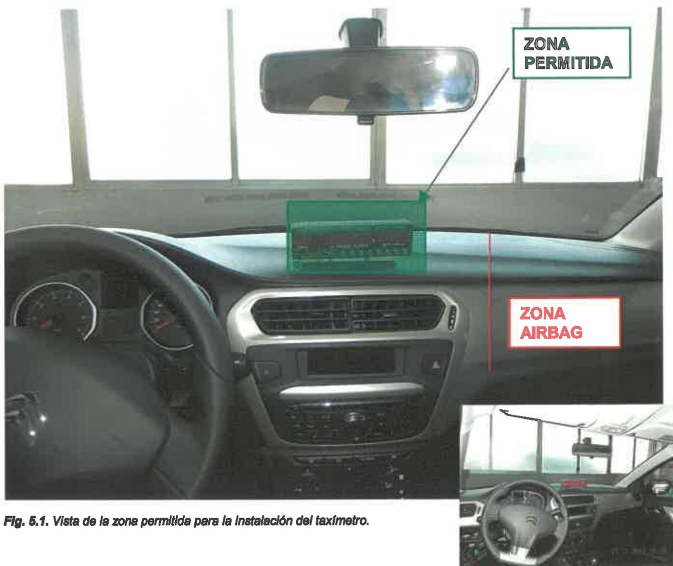
**Fig. 5.1. Vista de la zona permitida para la instalación del taxímetro.**
