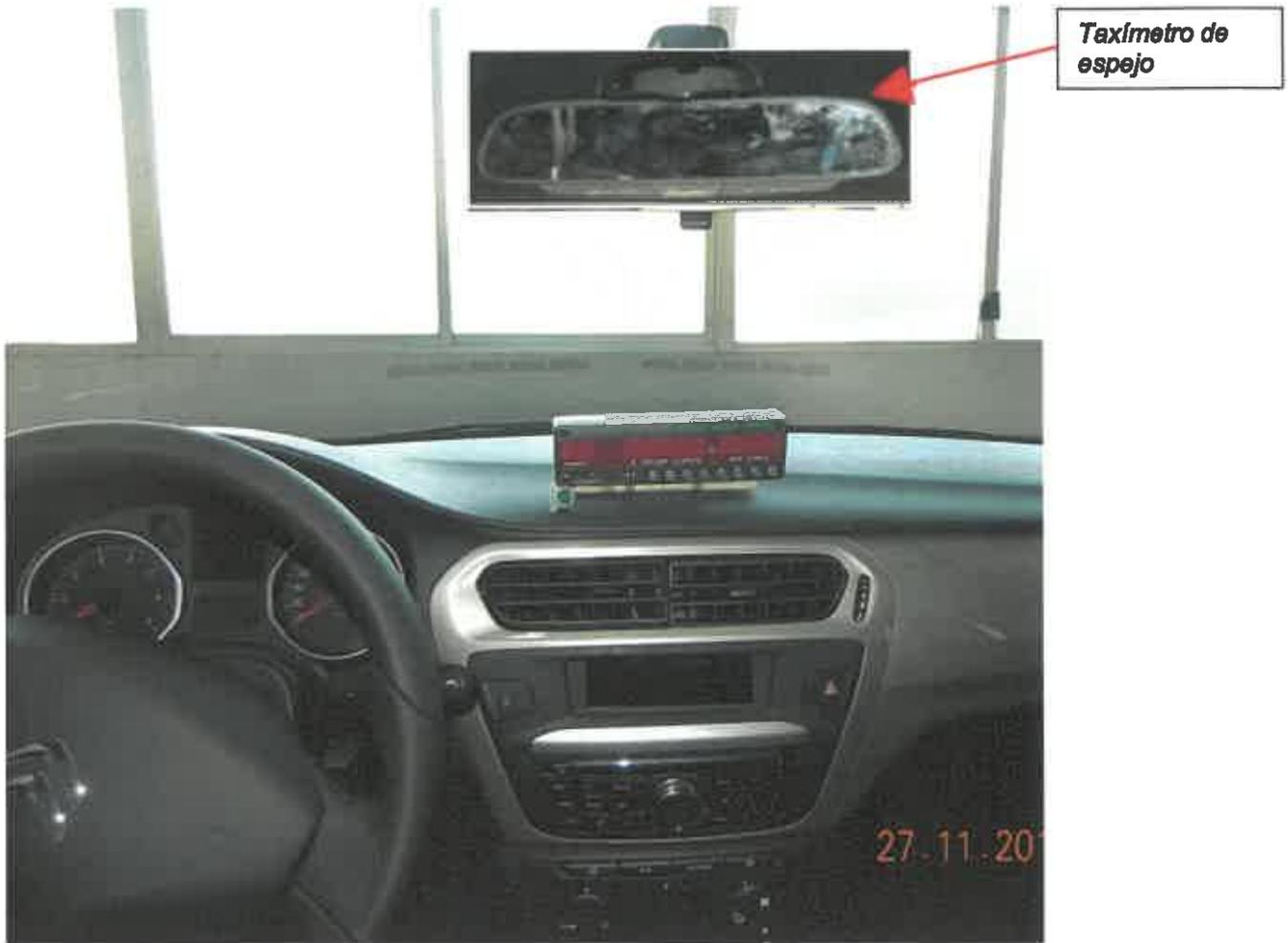
*Fig. 9.1. Vistas de la disposición del taxímetro de espejo.*
