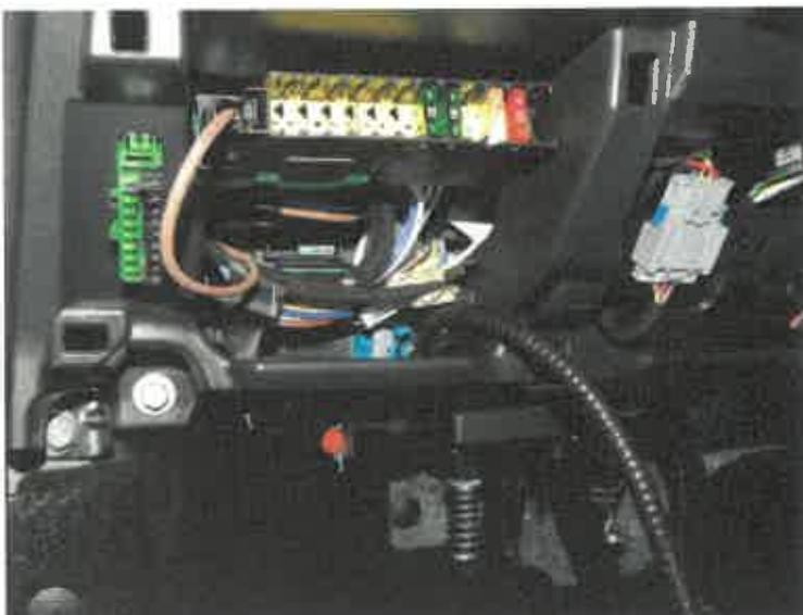
**Fig. 3.5.** Vista de la posición del cable corrugado.
