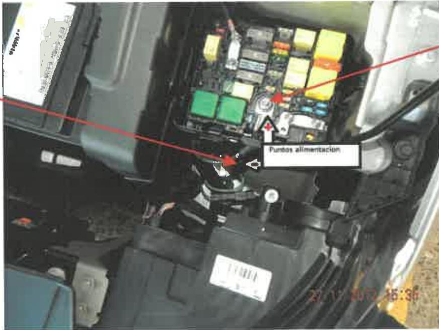
**Fig. 4.2.** Fotografía de los puntos de alimentación del vehículo a la caja adaptadora de señal.
