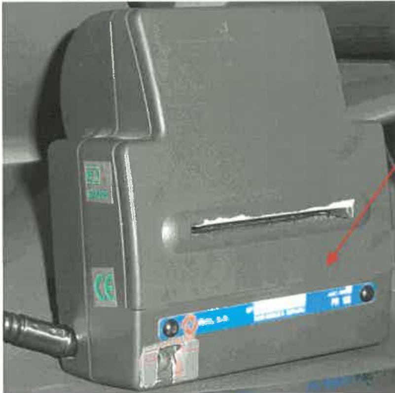
*Impresora fijada mediante "velcro" al panel interior*
