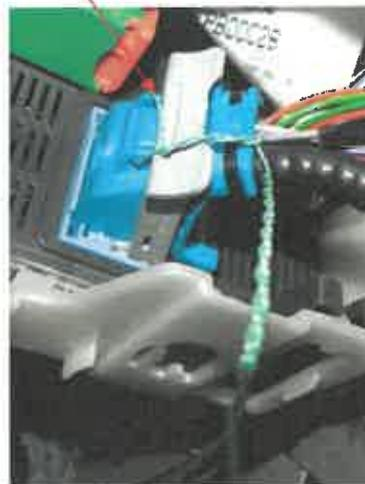
**Fig. 3.1. Precintado de la caja que contiene el conector 60V BE.**
