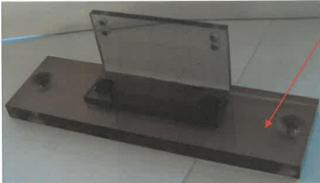
**Soporte fijado mediante tornillos al panel interior.**
