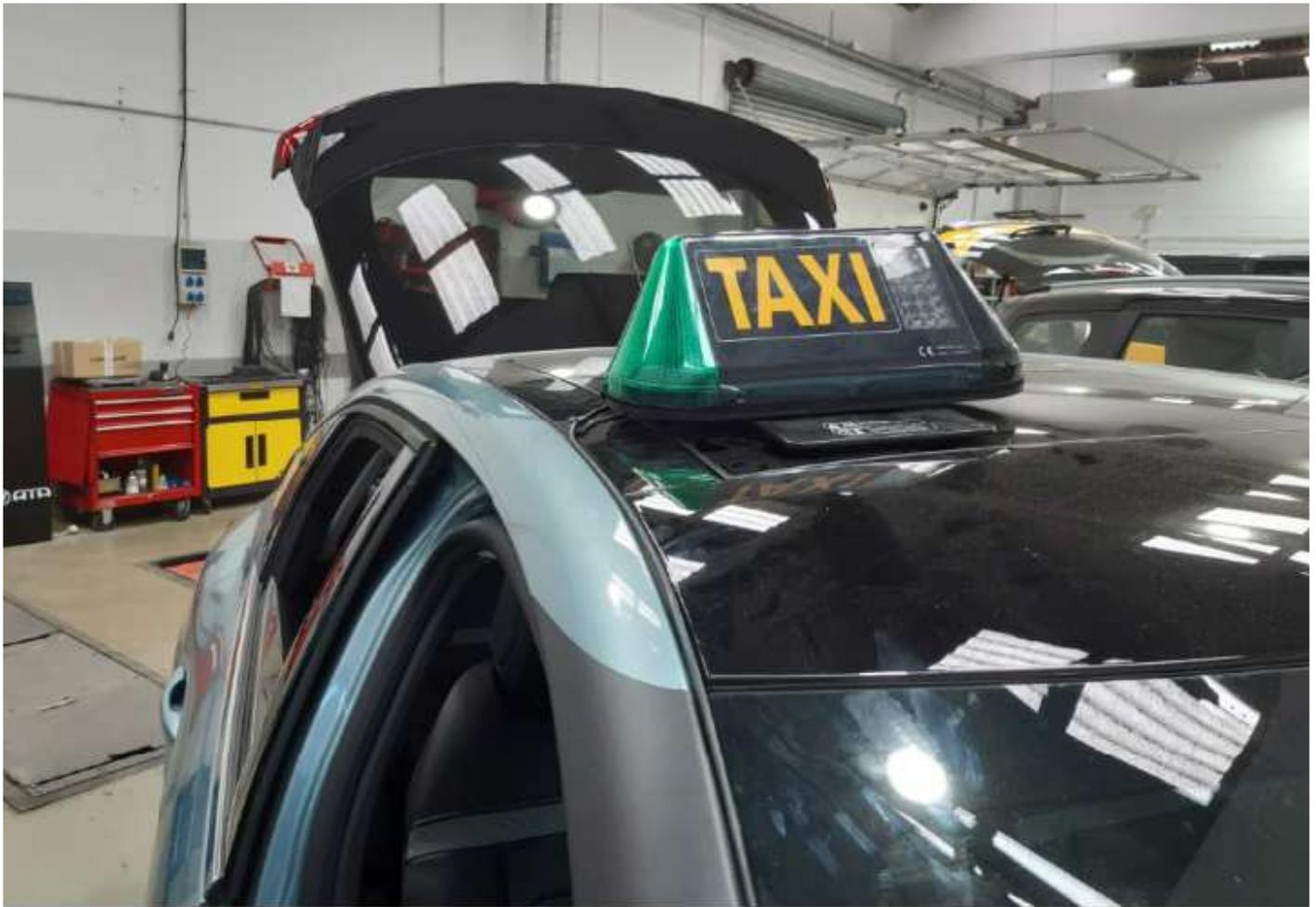
Una vez situado el módulo tarifario sobre el techo , encaminamos el cable de alimentación del módulo , por el vierte aguas derecho (en sentido conductor).
