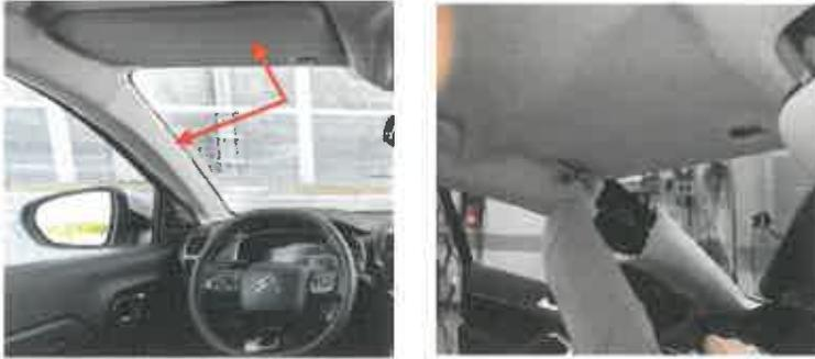
Encaminamos el mazo del taxímetro de espejo desde el interior del guarnecido de techo hasta el montante lateral, teniendo en cuenta, que este debe pasar por encima del Airbag lateral.
