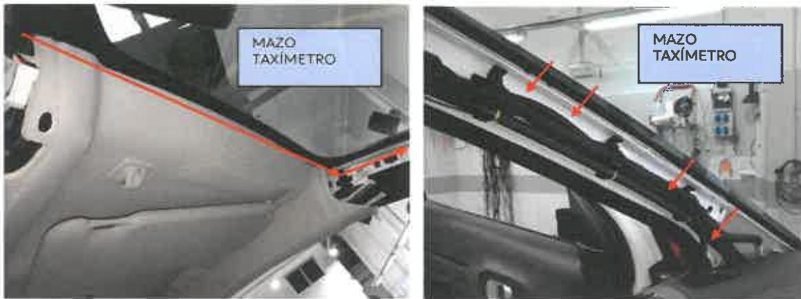
**ATENCIÓN: El mazo del taxímetro de espejo debe ir por encima del airbag lateral.**
