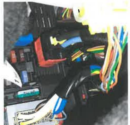
Una vez realizada la conexión de positivo con sus correspondientes fusibles, llevaremos un positivo y un negativo de batería hasta la caja adaptadora de señal situada en la zona de la BSI bajo volante lado conductor.
