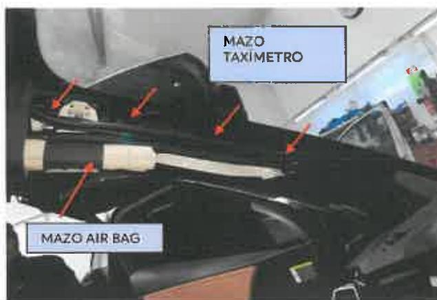
**ATENCIÓN: El mazo del taxímetro de espejo debe ir por encima del airbag lateral.**
