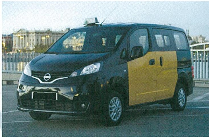
Debido a la forma de chapa ondulada del techo del vehículo, no es posible la instalación de un módulo tarifario con base imantada directamente sobre el techo, siendo necesario colocar una platina metálica autoadhesiva de 340 x 140 mm, sobre el primer hueco entre nervaduras asegurando así una superficie continua que sirva para la correcta sujeción de la base imantada del módulo.
