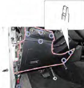
3. Desconecte los conectores del interruptor del panel protección inferior (A).
