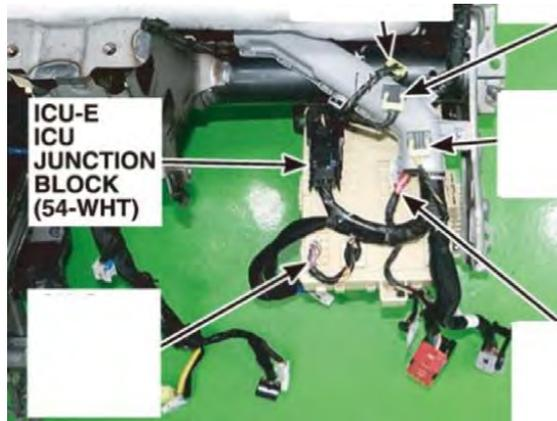
Fig. 2.3. Vista posterior del conector ICU-E.
