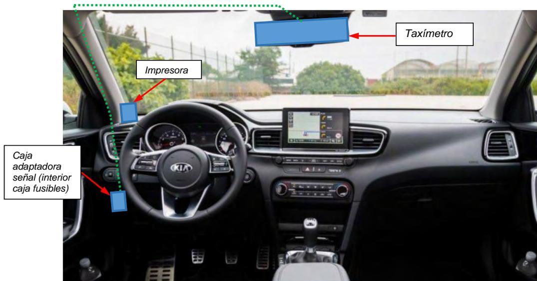
Fig. 4.1. Esquema orientativo de conexiones
