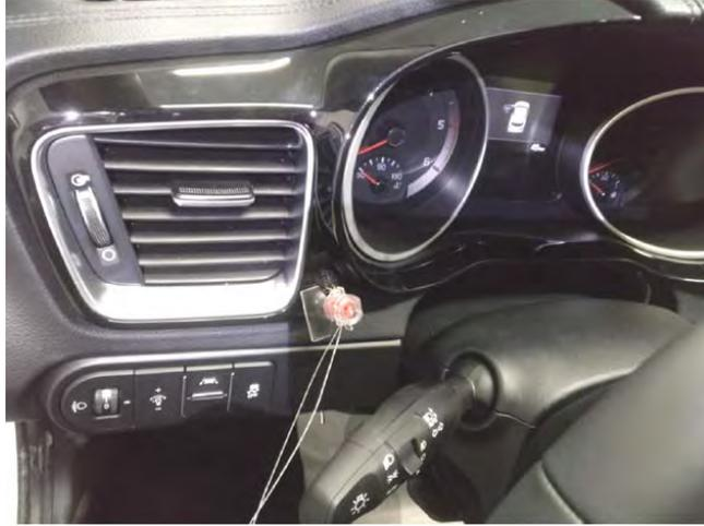
*Fig. 1.7. Vista del precintado del cuadro de instrumentos.*
