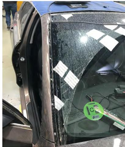
Fig. 6.5. Recorrido del cable del módulo por el exterior del marco del prabrisas
