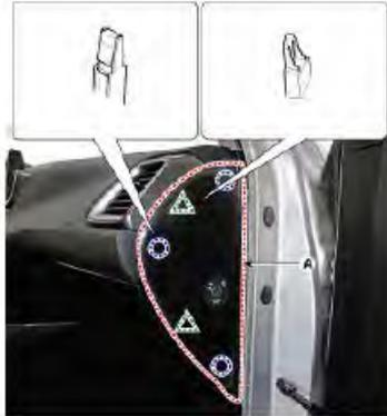
2. Desconecte el conector del airbag [RH] (A).
