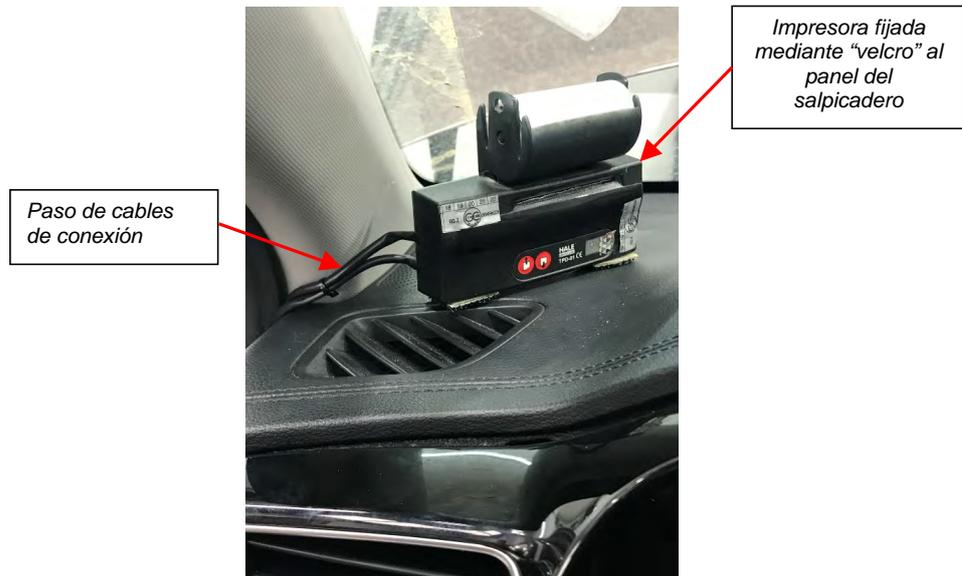
Fig. 5.2. Vistas de la disposición de la impresora.
