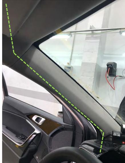
Fig. 6.2. Vista recorrido del cableado entre el módulo y la caja adaptadora de señal
