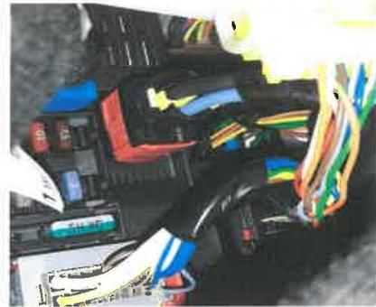
Una vez realizada la conexión de positivo con sus correspondientes fusibles, llevaremos un positivo y un negativo de batería hasta la caja adaptadora de señal situada en la zona de la BSI bajo volante lado conductor.
