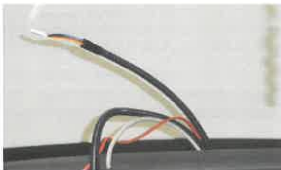
Mangueras pasadas por el taladro del salpicadero.
