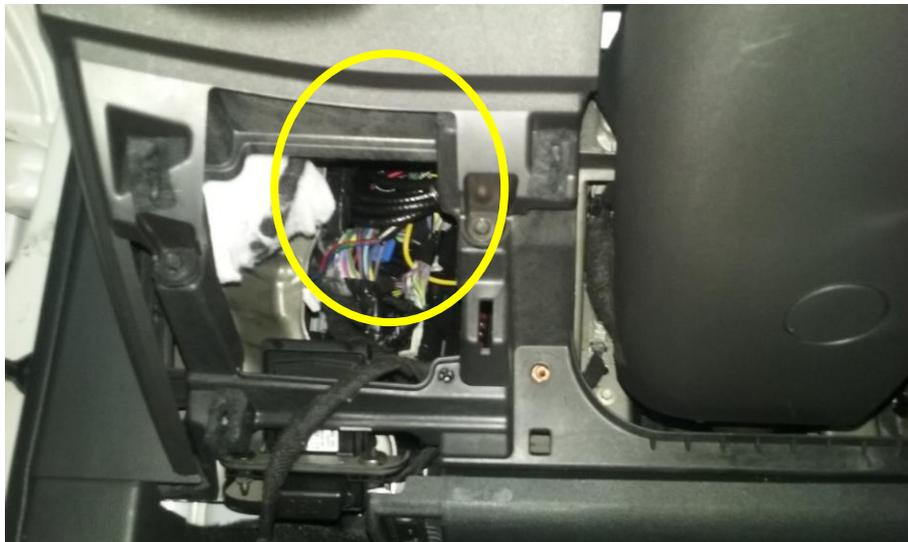
Hemos de llevar los cables a la zona del retrovisor. Para ello éstos transcurrirán por el pilar A del lado del conductor.
