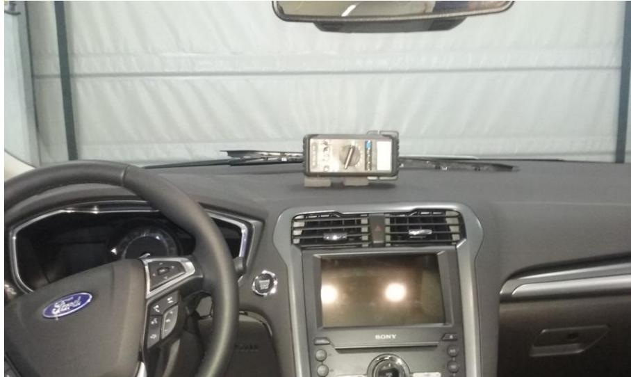
Queda a decisión del taller instalador donde practicar los taladros para la fijación del taxímetro y su plataforma si bien se harán de modo que no interfieran ni se acceda al sistema de ventilación del habitáculo.
