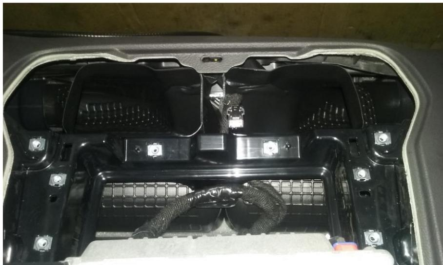
No perforar la cara superior de los conductos de ventilación
