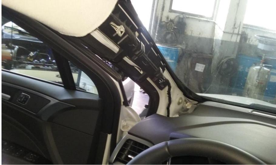
Volvemos a recurrir a la guía para el paso del cableado a la zona izquierda de la columna de dirección al entronque del Pilar A.
