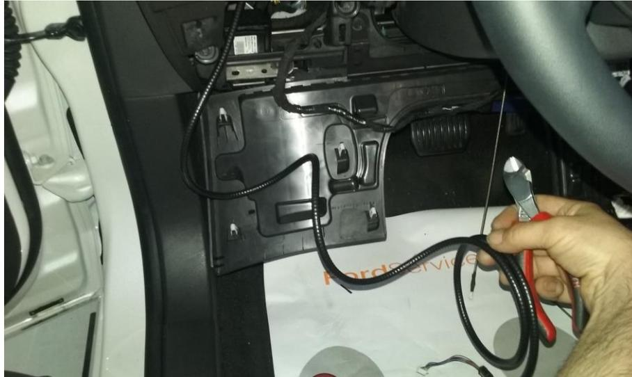
Recordemos que en esta preinstalación la manguera blindada contiene la toma de "señal de velocidad" para taxímetro – la única de las cuatro que es obligatoria su blindaje - y también por otro las tomas de "Masa", de "Contacto, Bajo Llave o 15" y de "Positivo Directo" que recordemos tenían incorporado un fusible de 5 Amperios y que han quedado en la zona del módulo de control del vehículo.
