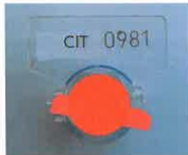
El precinto a instalar por los concesionarios de CITROËN será del tipo Roto-Tool / Roto-Seal, con las siguientes características:
