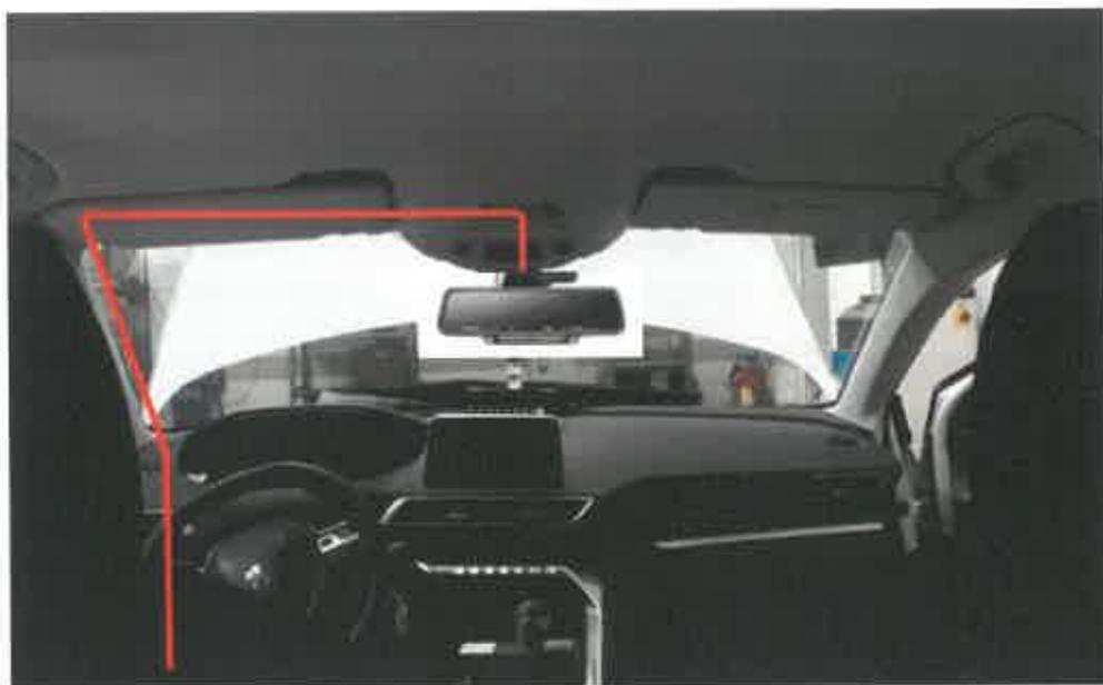
Desde la parte de la BSI , ahora llevaremos el cable de conexión de la impresora al taxímetro , hasta la parte de la consola central.
