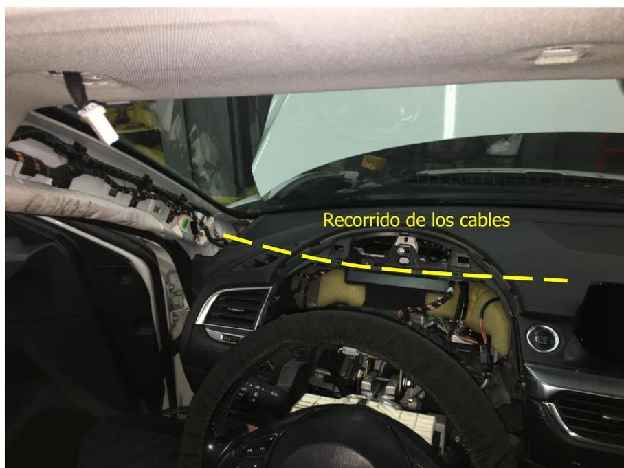
Desmontamos el pilar A con la ayuda de una espátula teniendo cuidado de no romper la grapa superior que sujeta el guarnecido. Los cables y la manguera subirán por el pilar hasta el guarnecido del techo.
