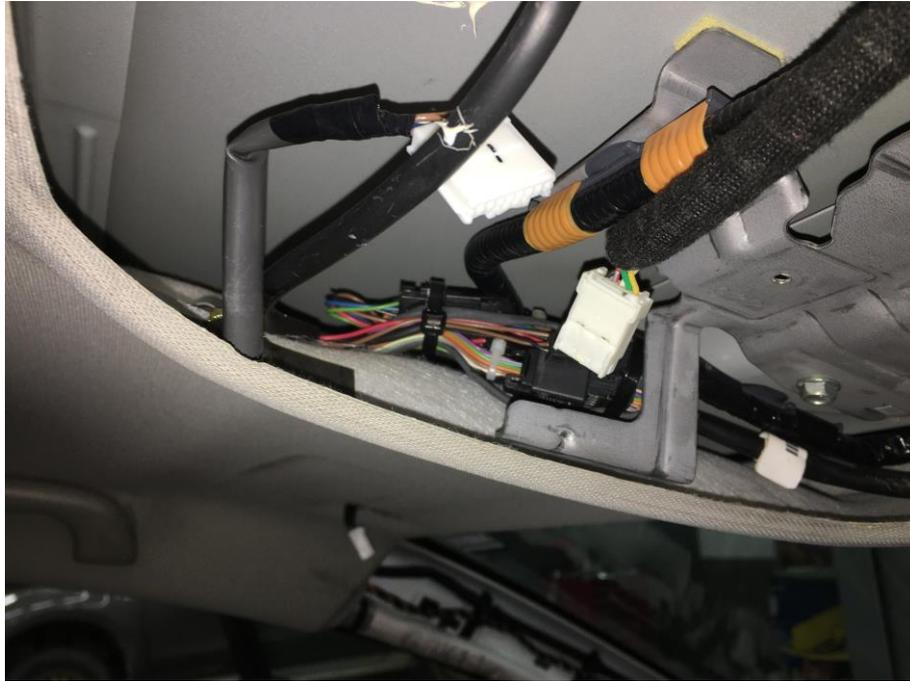
(Dependiendo de las versiones de equipamiento del vehículo podemos vernos obligados a tener que desmontar parte del guarnecido del techo para un mejor acceso y operatividad.)
