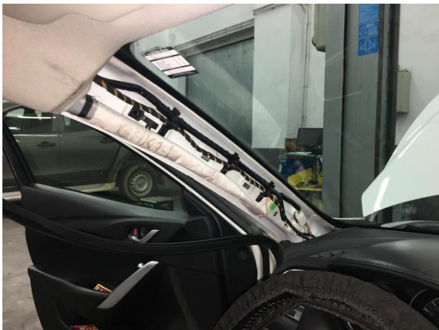
Para el paso de los cables por la zona del techo se sugiere el desmontaje del parasol. El desmontaje de la sujeción del parasol del conductor ayuda al paso de los cables.
