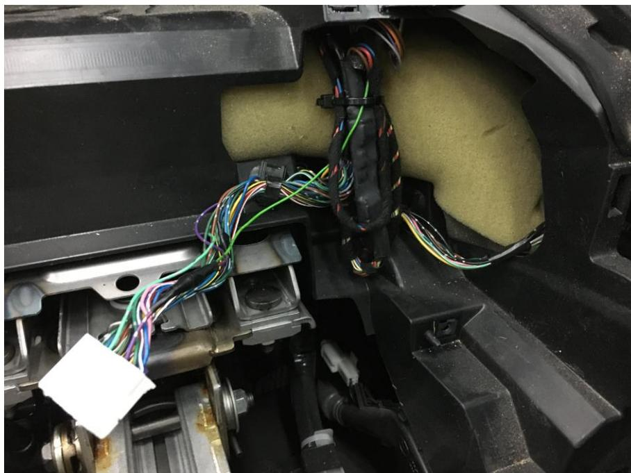
Ya tenemos acceso al cable de toma de señal. Para el resto de tomas recurriremos a una guía rígida flexible para el paso de los cables por la zona interior del salpicadero desde la zona inferior izquierda de la columna de dirección al encuentro del cableado del taxímetro, o al revés, del salpicadero a la zona inferior izda. de la columna al encuentro de la preinstalación del fabricante.
