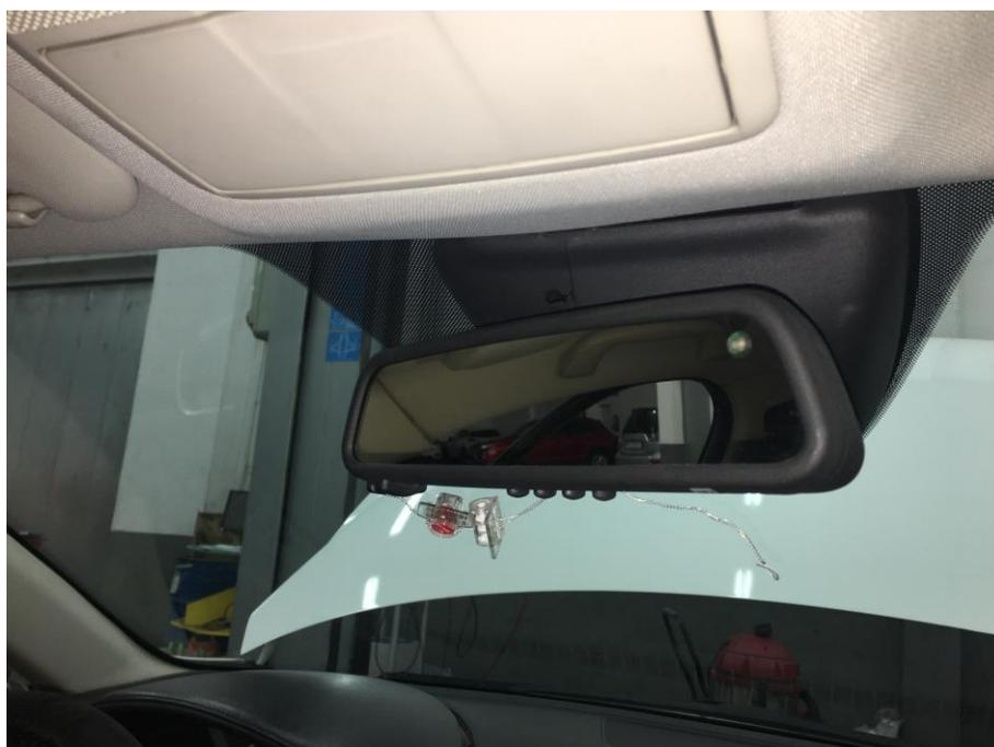
Iniciamos operaciones de nuevo desde el taxímetro de modo que los cables irán al punto donde tenemos la preinstalación hecha por parte del fabricante. Hemos de llevar los cables desde la zona del retrovisor a las tomas de la preinstalación. Para ello éstos transcurrirán por el pilar A del lado del conductor.
