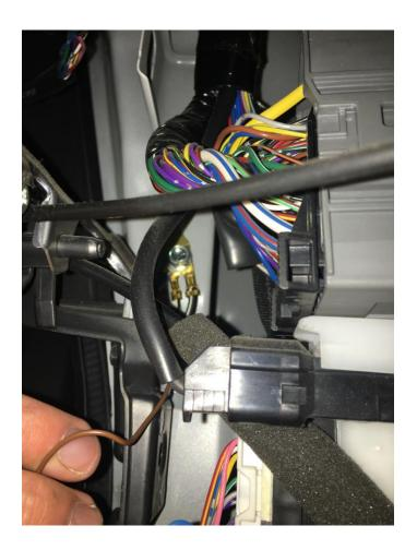
Recurrimos al tornillo original del vh. que desatornillaremos para incluir la nueva toma de masa. La toma de masa G13 queda por encima de la caja de fusibles F-02 sobre la que vamos a trabajar para tener las siguientes tomas que necesitan el taxímetro y sus accesorios.
